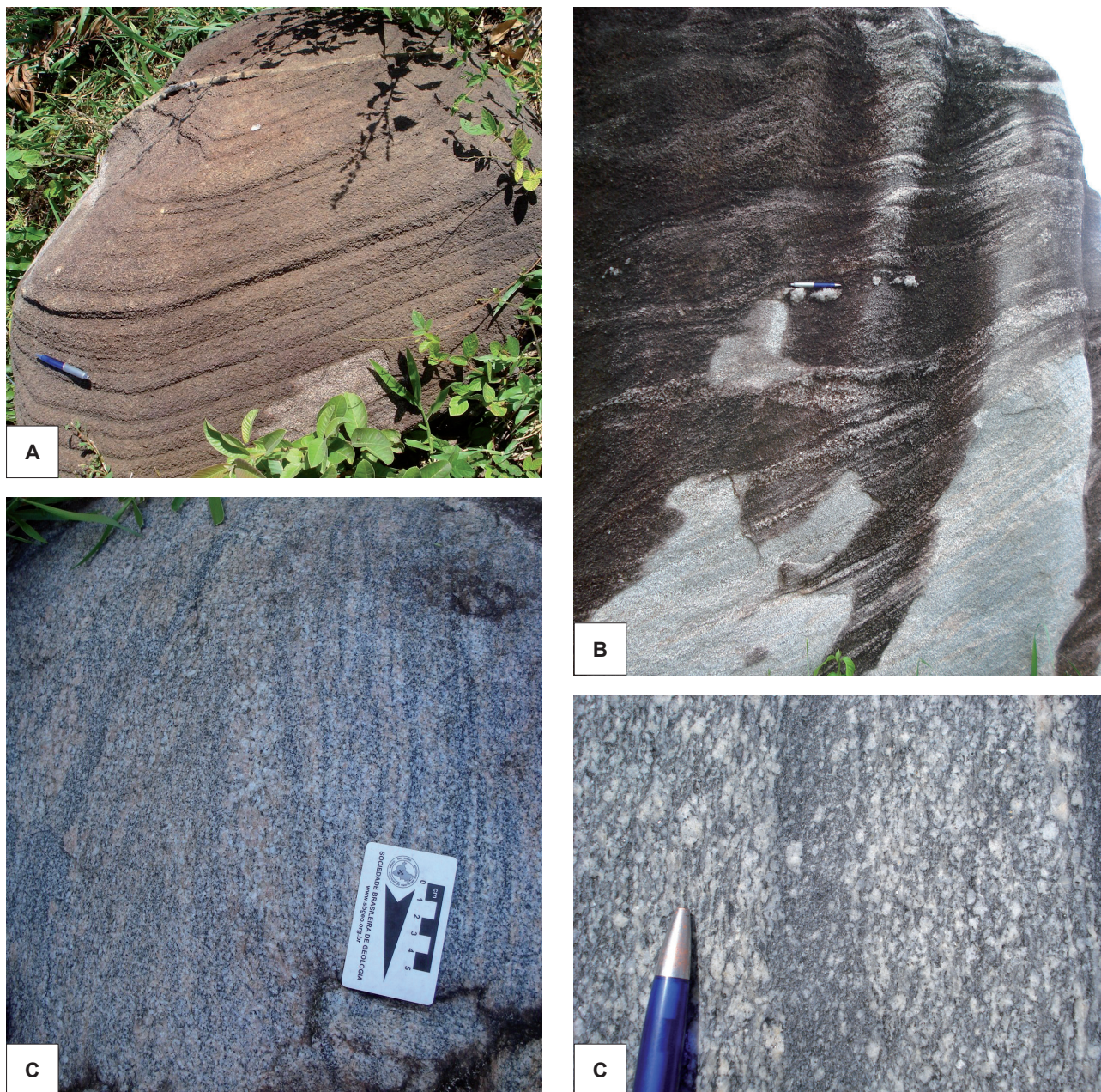
Figura 4.12 – A a D) Exemplos de acamamento magmático ( S_a ) proeminente em monzogranitos da Suíte Intrusiva João Jorge. Em “D” notar cristal euédrico de plagioclásio no nível cinza escuro, atestando o caráter magmático do acamamento. Nas fotos B, C e D nota-se que a S_a e S_p são concordantes. A: Estação FB-31 (UTM 499915/9609080); B e C: Estação FB-47 (UTM 466015/9597464); D: Estação FB 79 (UTM 495245/9574522).
