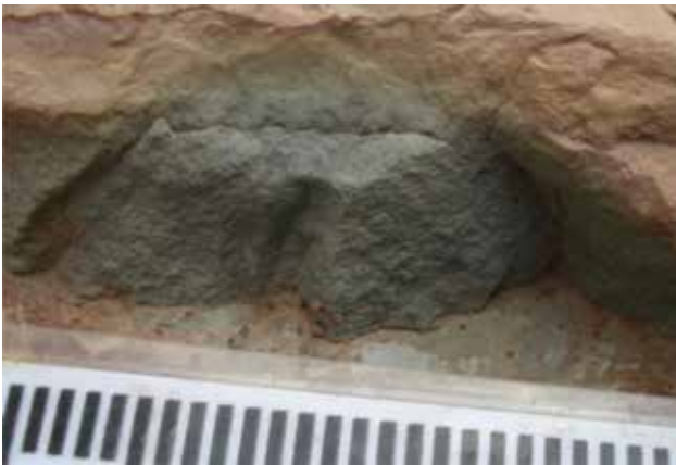
Figura 3.8. Detalhe de amostra de arenito da Formação Três Marias, exibindo típica coloração verde clara, passando a rósea nas partes mais intemperizadas (MK1251 – 540396/7945985).
