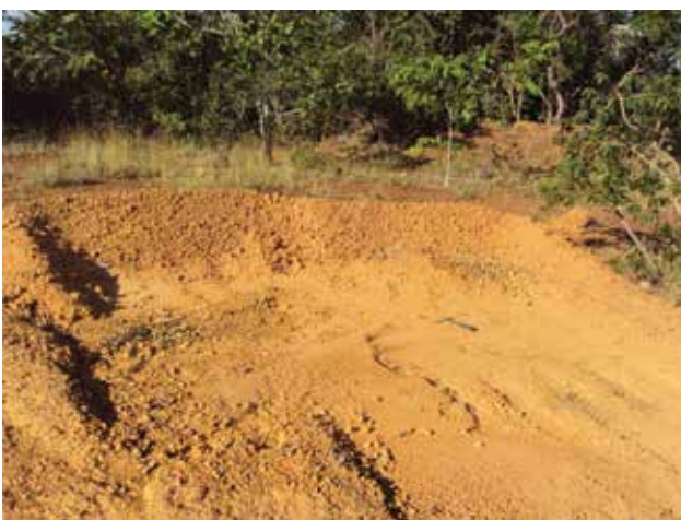
Figura 3.13. Cascalho laterítico retirado como material de empréstimo para o calçamento de estradas (MK 1342 – 505248/ 7924317).
