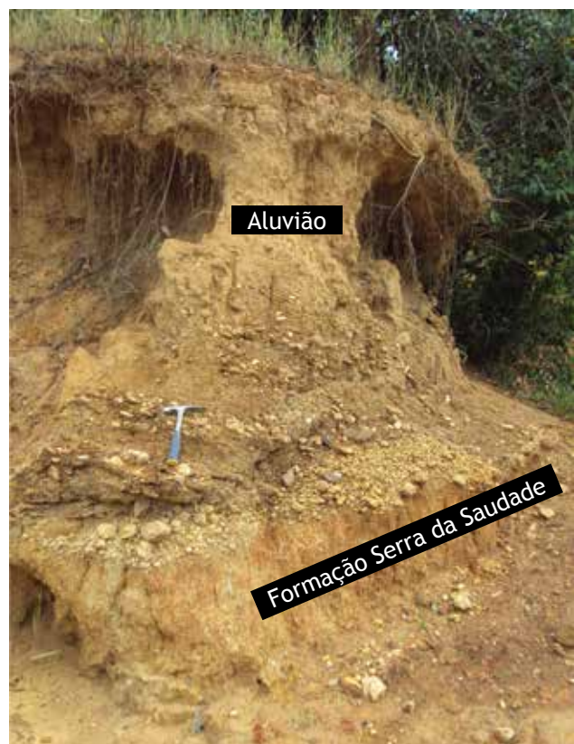
Figura 3.15. Depósito areno-cascalhoso associado ao Córrego Jacarandá, assentado sobre pelito da Formação Serra da Saudade (MK 916 – 550728/ 7947900). Notar estratificação cruzada na porção rudítica.
