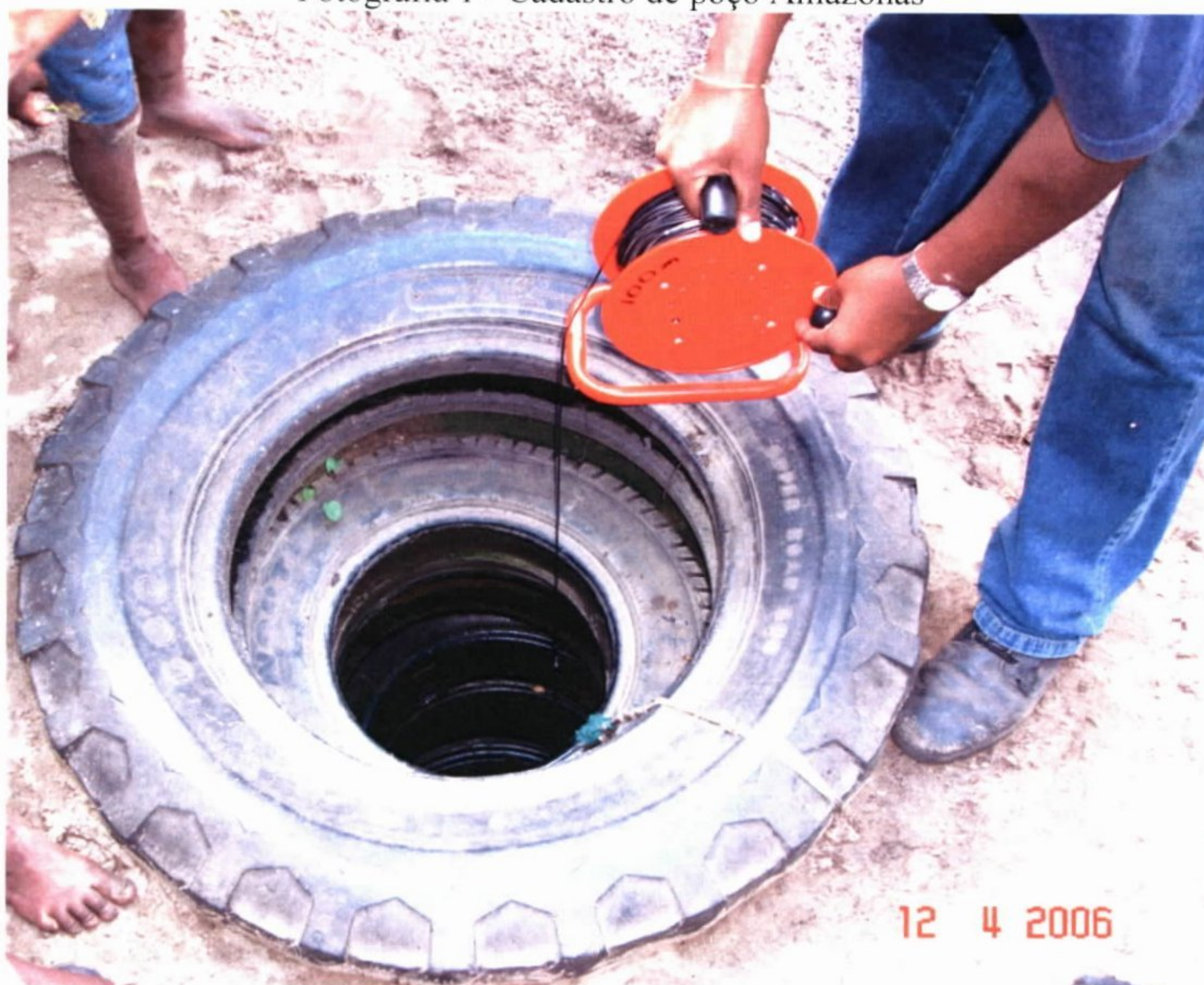
Fotografia 2 - Medição de nível estático
