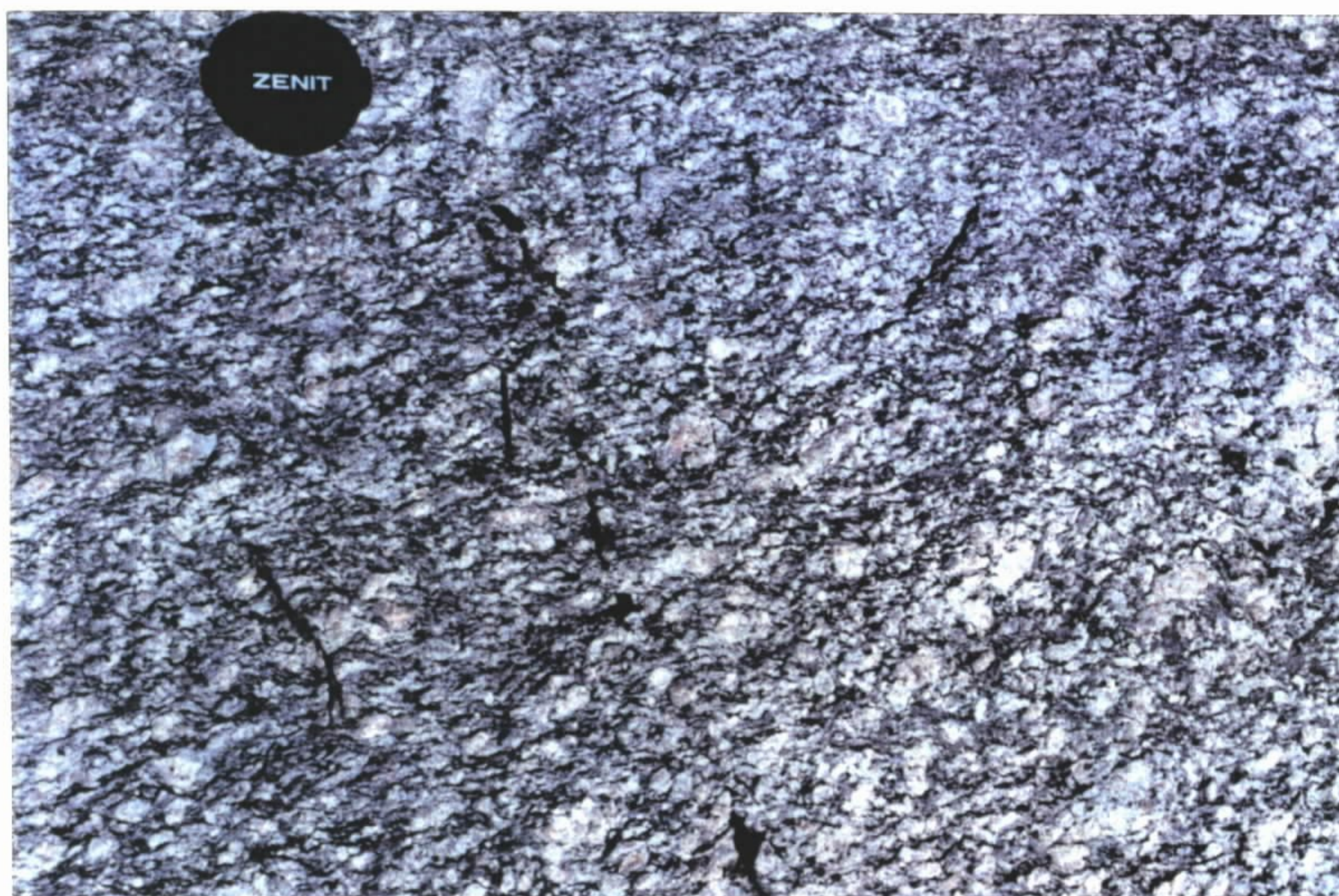
Foto 7 - Detalhe de afloramento representativo do Complexo Metamórfico Momene, considerado unidade do Complexo Chiquitania. Apresenta textura augen, com grãos centimétricos de feldspato-K e quartzo estirados.
