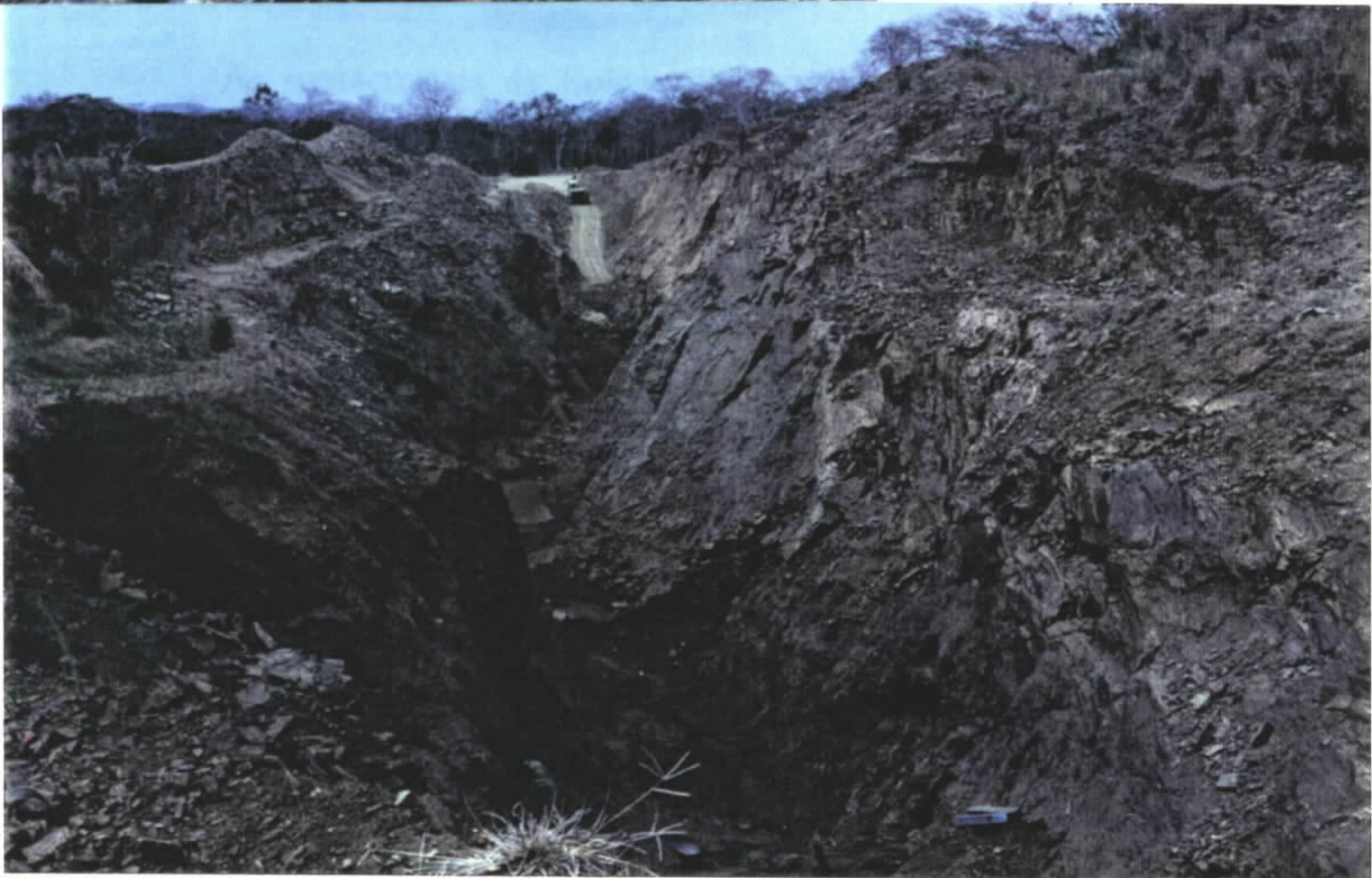
Foto 11 - Garimpo do Eupídio (brasileiro) ponto 04 da Fig. 2, onde a lavra de ouro se processa numa zona de cisalhamento de alto ângulo, com 400 m de extensão e 10 m de largura, em rocha básica com veios de quartzo com sulfetos associados.
