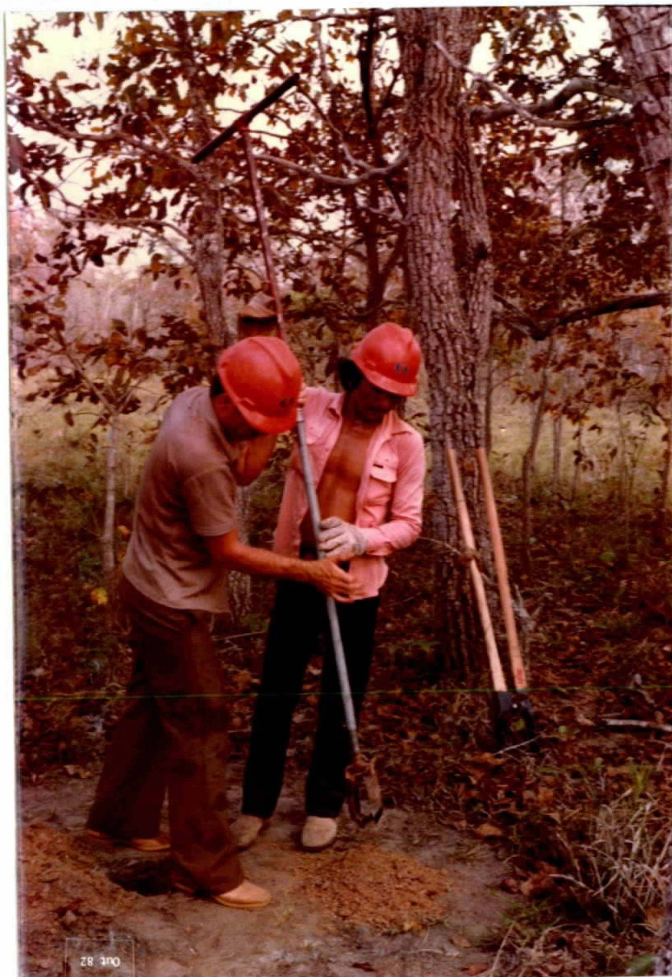
FOTO 04 - Trado caçamba de 4", utilizado para ultrapassar a cobertura argilosa, durante as operações de ve rificação da presença ou não de camadas de casca lho .
