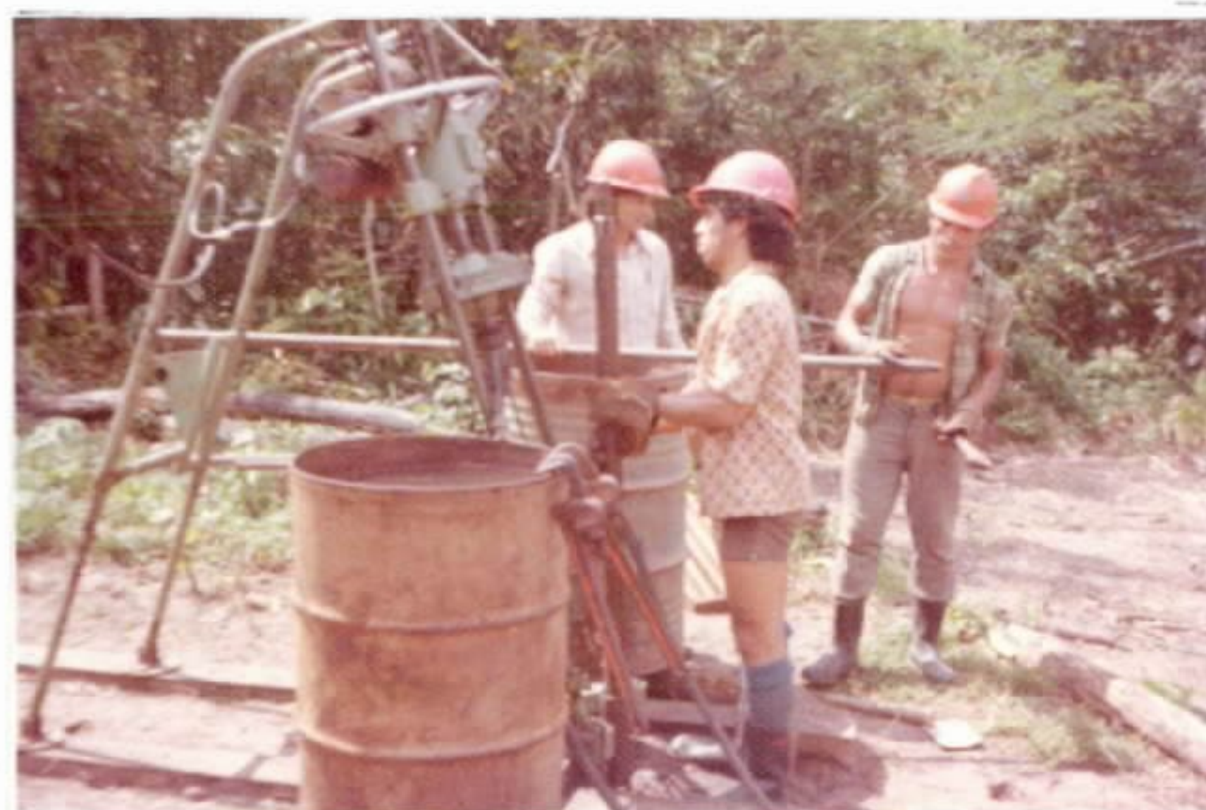
Operação da sonda rotativa Winkie GW-15, em fase de manobra.
