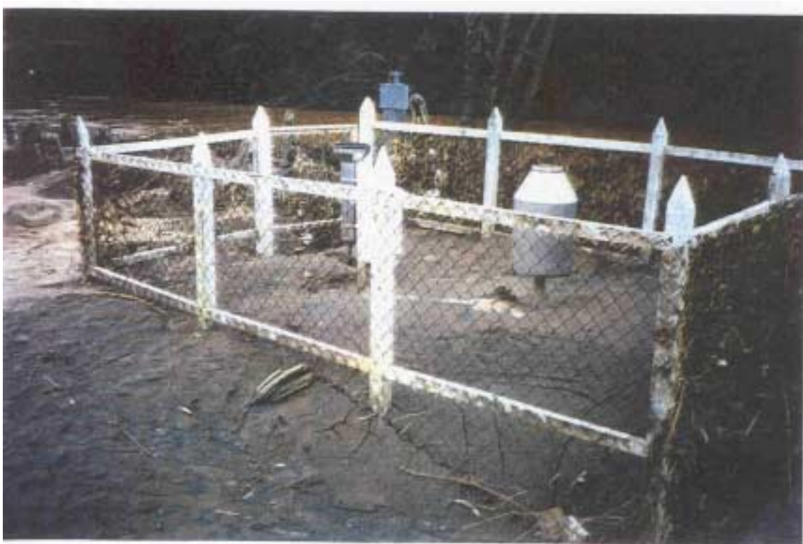
Estação Ponte Nova do Paraopeba (40800001) – Estação pluviográfica quase que completamente coberta por sedimentos
