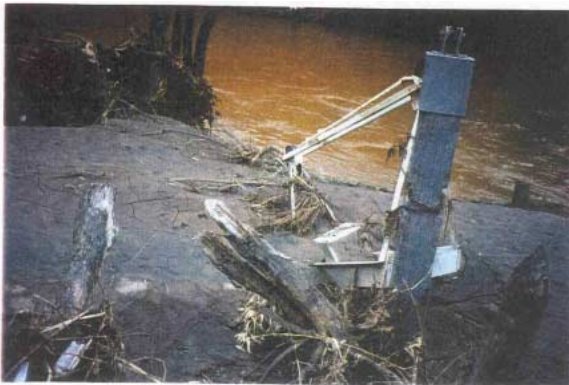
Estação Ponte Nova do Paraopeba (40800001) – Estação pluviográfica quase que completamente coberta por sedimentos
