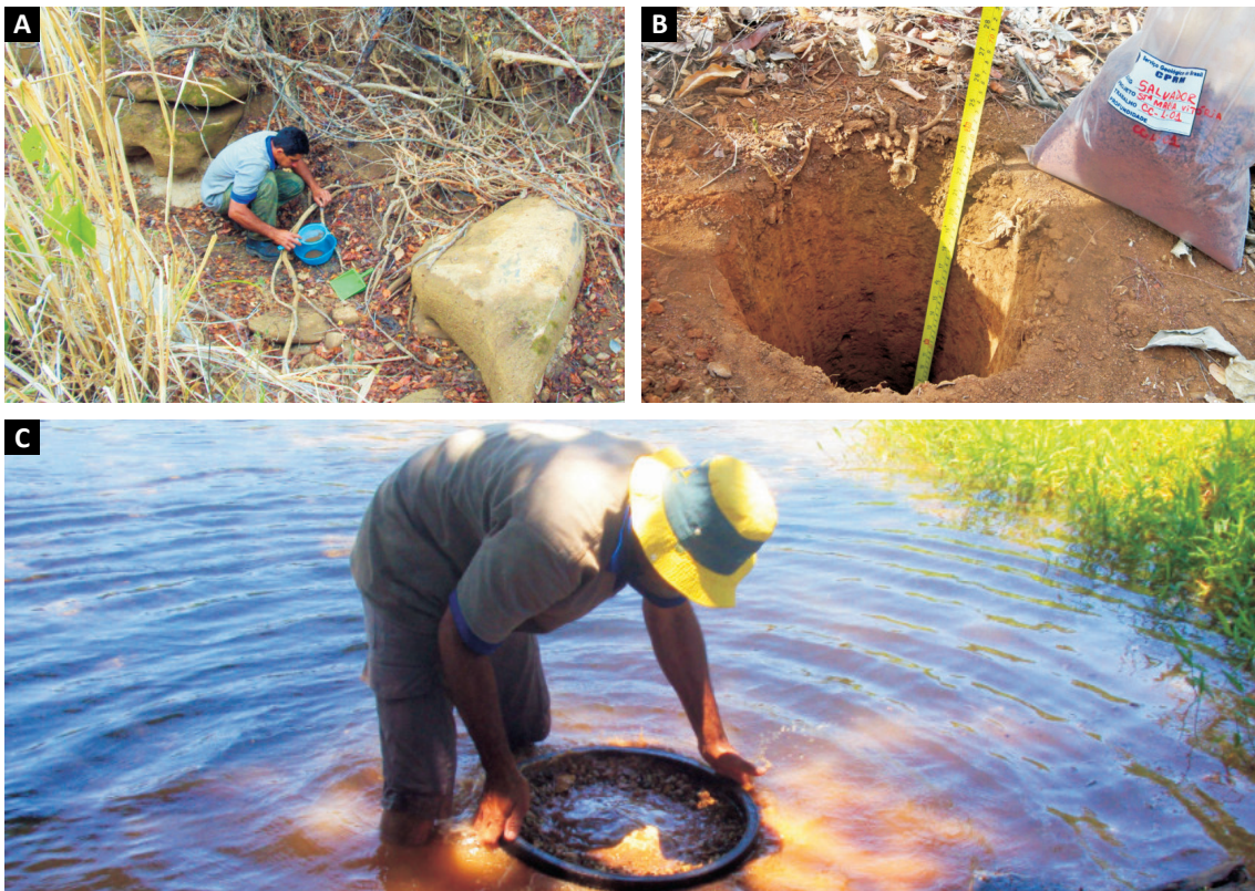
Figura 6.2 - (A) Exemplos de estações de coleta de sedimento de corrente; (B) Amostragem de solo; (C) Preparação de amostras de concentrado de bateia
