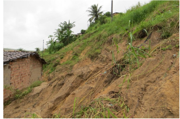
Solo arenoargiloso é suscetível à erosão e rupturas, com escorregamentos planares rasos
