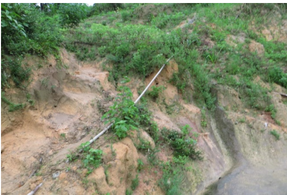
Cicatrizes marcam a ocorrência de vários escorregamentos na encosta, que se encontra saturada e com vegetação rala. A proximidade das moradias à base da encosta, e a ausência de drenagem de crista e base da encosta, são fatores que potencializam o grau de risco na área
