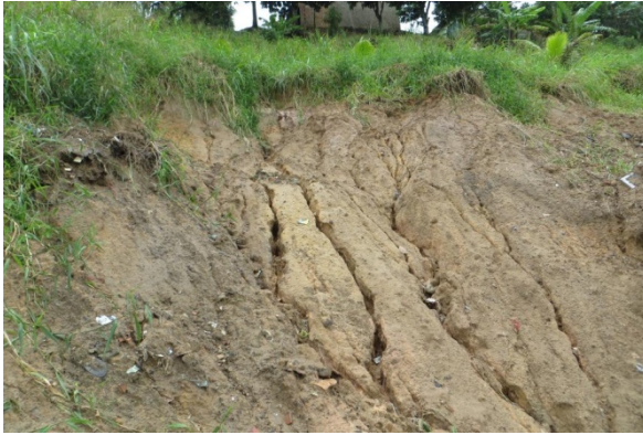
Solo arenoargiloso é suscetível à erosão e rupturas, com escorregamentos planares rasos
