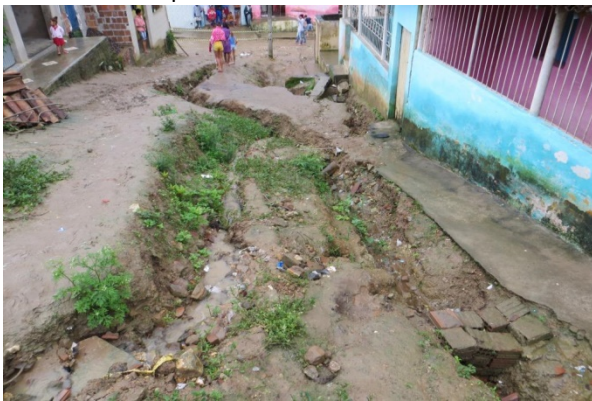
O contato solo-rocha, onde se vê a pequena espessura do solo residual.
