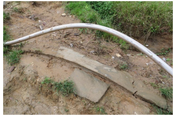
A compressão provocada pelo escorregamento solo-sobre-rocha provocou a deformação da tubulação adutora da rua
