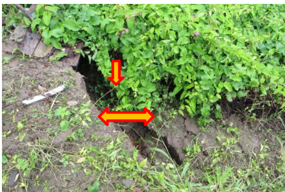
Continuidade lateral da trinca no terreno, com formação de degraus de abatimento e ramificações visíveis, que destruíram por completo uma moradia de qualidade construtiva inferior às mostradas acima
