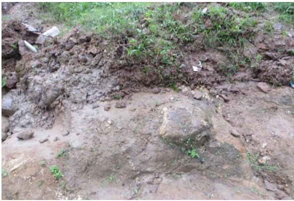
O contato solo-rocha, onde se vê a pequena espessura do solo residual.
