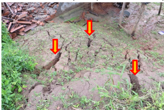
Continuidade lateral da trinca no terreno, com formação de degraus de abatimento e ramificações visíveis, que destruíram por completo uma moradia de qualidade construtiva inferior às mostradas acima
