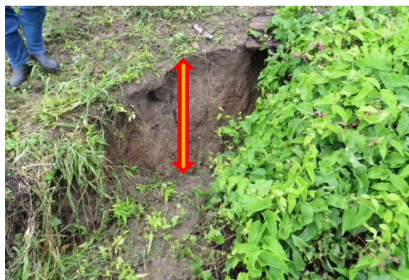
Continuidade lateral da trinca no terreno, com formação de degraus de abatimento e ramificações visíveis, que destruíram por completo uma moradia de qualidade construtiva inferior às mostradas acima
