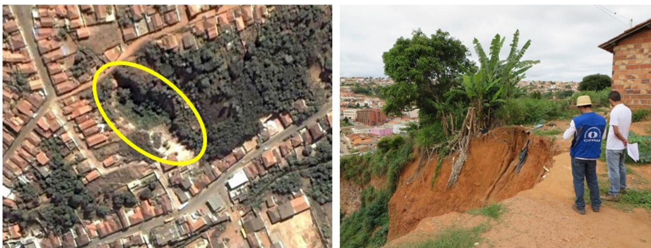
Figura 04 - Voçoroca com margens habitadas previamente identificada durante a etapa de fotointerpretação. Fotos: imagem orbital Google (esquerda) e acervo SGB-CPRM (direita).
