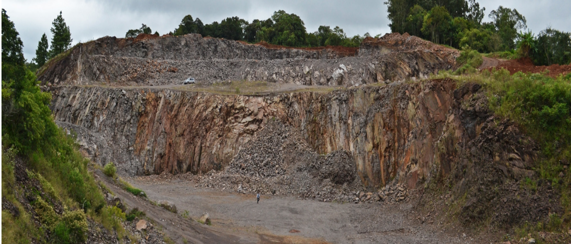
Figura 4.11 - Frente de lavra W da Pedreira Pinheiral, no distrito de Pinheiral, a NE da zona urbana de Santa Cruz do Sul. Notar disjunção concêntrica com aspecto de “calota”. À direita na foto, solo avermelhado com alteritos de rochas sedimentares silticas do Grupo Rosário do Sul. Foto Heinrich Theodor Frank .
