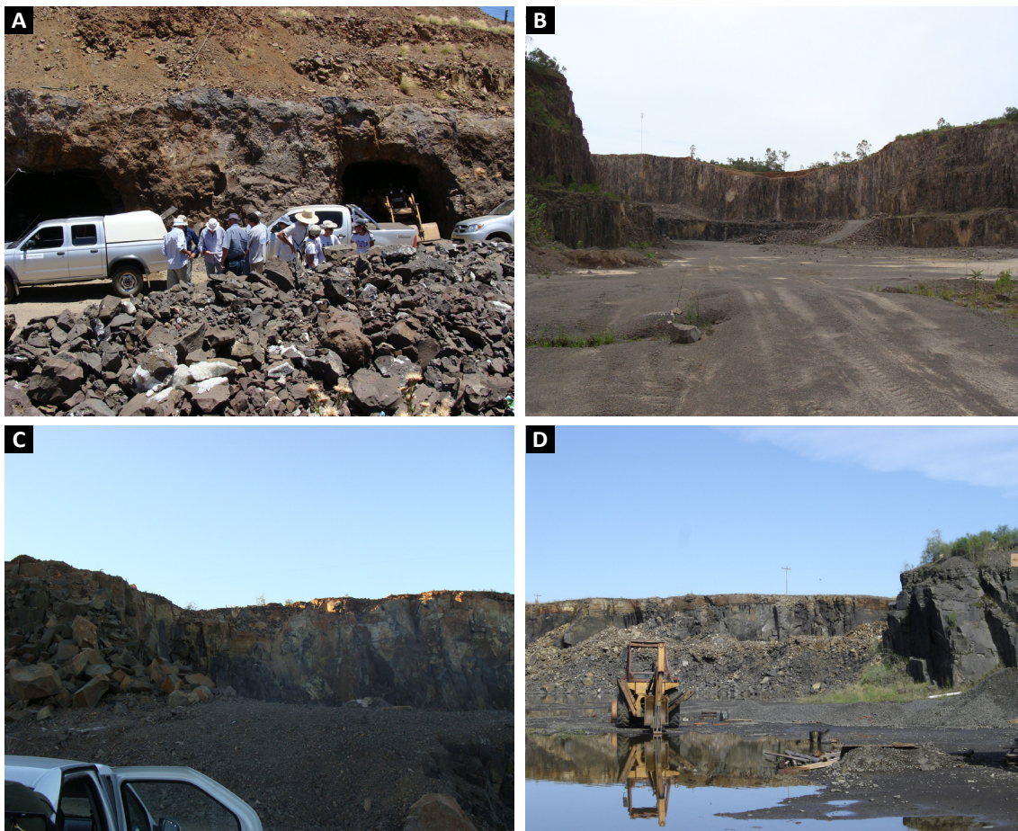
Figura 4.17 - (A) Lavra Cordillera, Uruguai. Notar em primeiro plano rochas encaixantes de geodos e brechas de topo de derrame (provenientes do teto das galerias de lavra) em pilha de rejeitos. (B) Pedreira Capilheira, na periferia norte de Santana do Livramento. Lavra de grande porte em sill de andesito basáltico. (C) Mineração Aprato, entre Rosário do Sul e Alegrete, Lavra em pequeno sill basáltico. (D) Pedreira Santa Rita, nas proximidades de Quaraí. Lavra de porte médio no terceiro derrame local.
