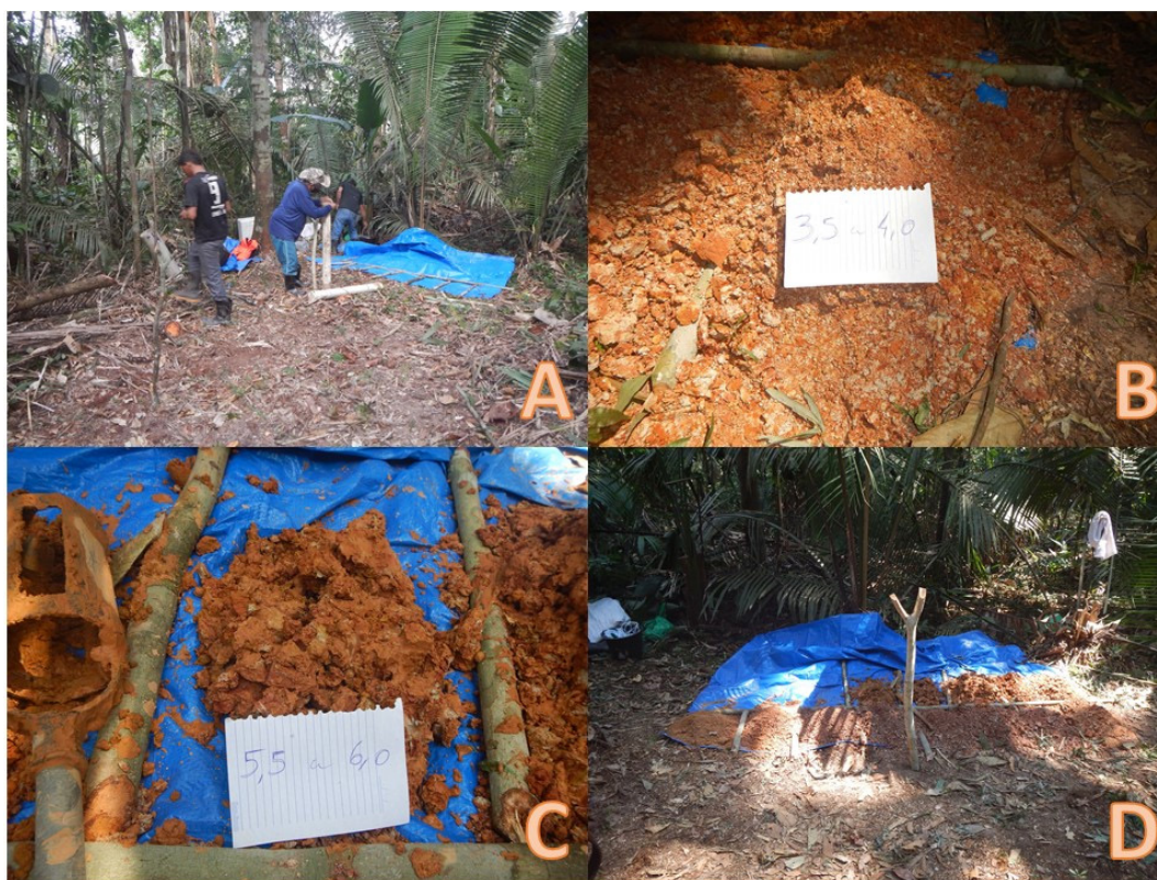
Figura 12 - Furo LAB-02. A) Início dos trabalhos de perfuração. B) Solo mosqueado, areno-siltoso, do intervalo entre 3,5 e 4,0 metros. C) Solo mosqueado branco e vermelho, areno-siltoso, com pintas de laterita e areia amarela, do intervalo entre 5,5 e 6,0 metros. D) Todas as amostras dispostas no final da perfuração.
