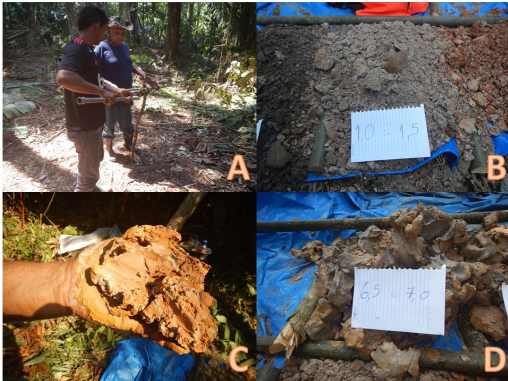
Figura 13 - Furo LAB-03. A) Processo de montagem do trado para o início da perfuração. B) Solo silto-argiloso do intervalo 1,0 a 1,5 metro. C) Solo siltoso, coeso, amostrado no intervalo entre 5,00 e 5,50 metros. D) Solo marrom silto-arenoso observado no intervalo 6,50 a 7,00 metros.
