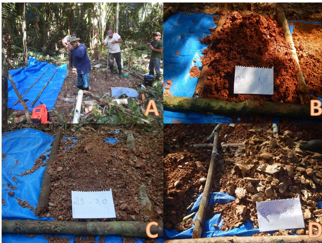
Figura 11 - Furo LAB-01. A) Início dos trabalhos de perfuração. B) Solo marrom-avermelhado do intervalo entre 0,50 e 1,00 metro. C) Solo mosqueado siltoso amostrado no intervalo entre 2,5 e 3,0 metros. D) Solo marrom silto-argiloso do intervalo final do furo (6,5 – 7,0m).
