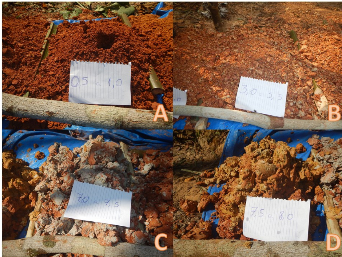
Figura 15 - Furo LAB-05. A) Solo marrom avermelhado, silto-argiloso, do intervalo entre 0,50 e 1,00 metro. B) Solo mosqueado, silto-areno-argiloso, amostrado no intervalo entre 3,00 e 3,50 metros. C) Solo mosqueado bege, com vermelho e amarelo, silto-argiloso, do intervalo entre 7,00 e 7,50 metros. D) Areia siltosa amarela encontrada no final do furo.
