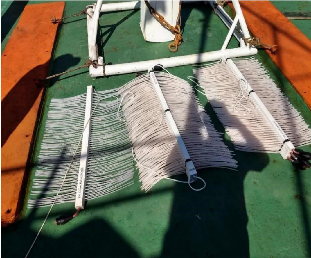
**Figura 6.13** - Sparker-eletrodos modelo ECL820 da SIG utilizado nas operações a bordo do NPq Atlântico Sul. Peso 1.8 kg, extensão 1 m, energia entre 750 e 1000 J e espectro de frequências entre 900-1400 Hz. Fonte: acervo fotográfico do Projeto Fosforita, SGB-CPRM / DIGEOM.
