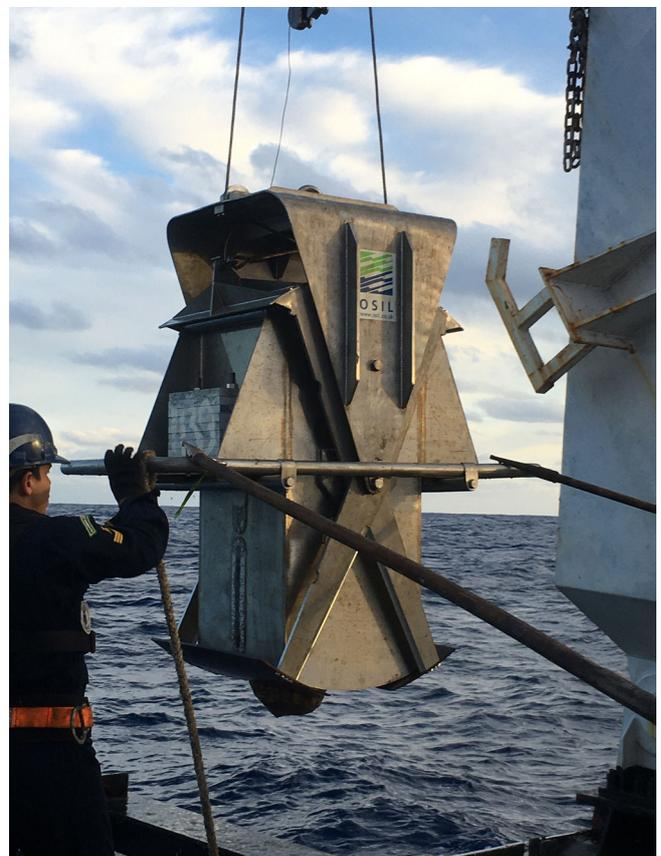
**Figura 5.9** - Amostrador Mega Box Corer Osil®. Fonte: acervo fotográfico do Projeto Fosforita, SGB-CPRM / DIGEOM.
