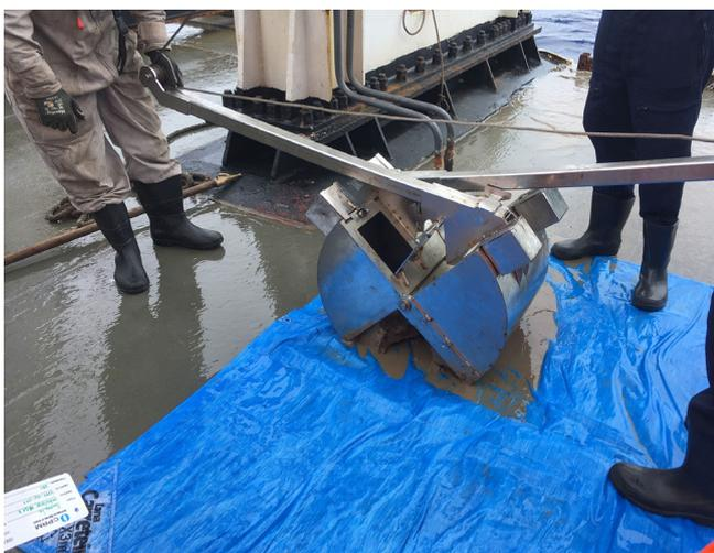
**Figura 5.11** - Amostrador Van Veen 50 litros. Fonte: acervo fotográfico do Projeto Fosforita, SGB-CPRM / DIGEOM.
