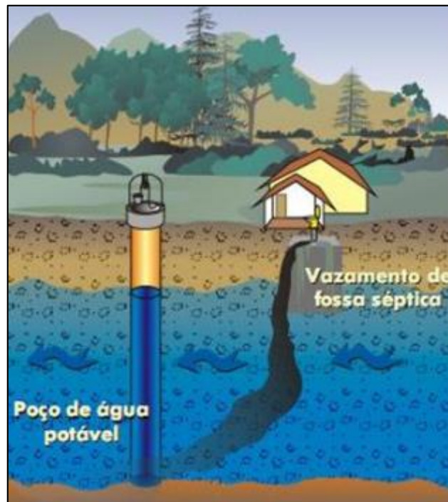
Figura 18 – Exemplificação de infiltração de contaminantes, oriundos do sistema séptico idêntico ao utilizado pela população em Porto Velho/RO. Fonte: Adaptado de Oliveira (2016).
