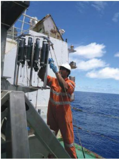
Figura 71: Coleta de água nas garras do tipo Niskin à direita e o laboratório a esquerda.
