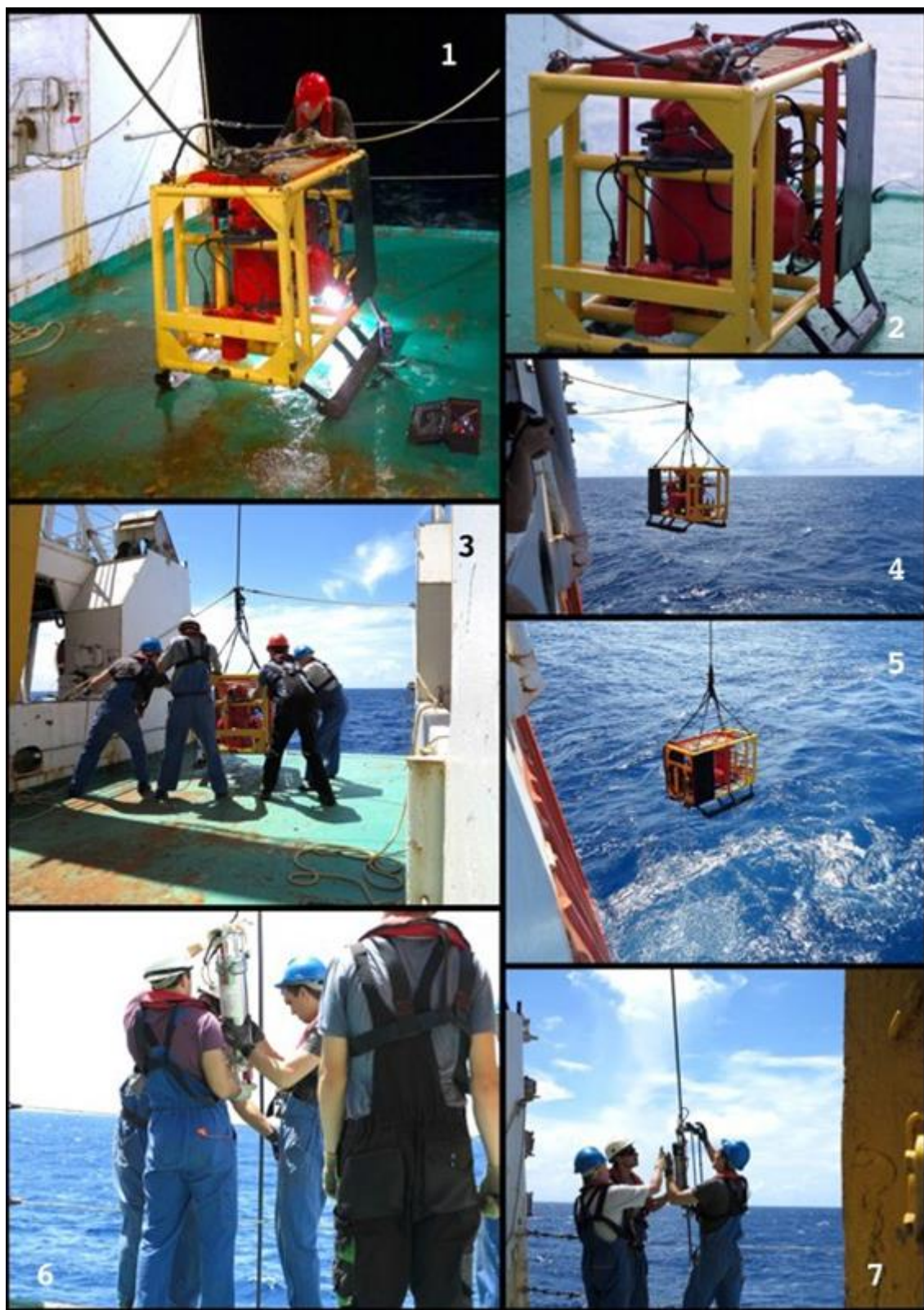
Figura 59: Sequência de lançamento do sistema de foto-filmagem Neptune. Checagem das luzes, laser de escala e câmera (1 e 2), lançamento do sistema na água (3 a 5) e colocação dos sistemas de posicionamento bacon (6) e perfiladores como o MAPR ou ADCP (7).
