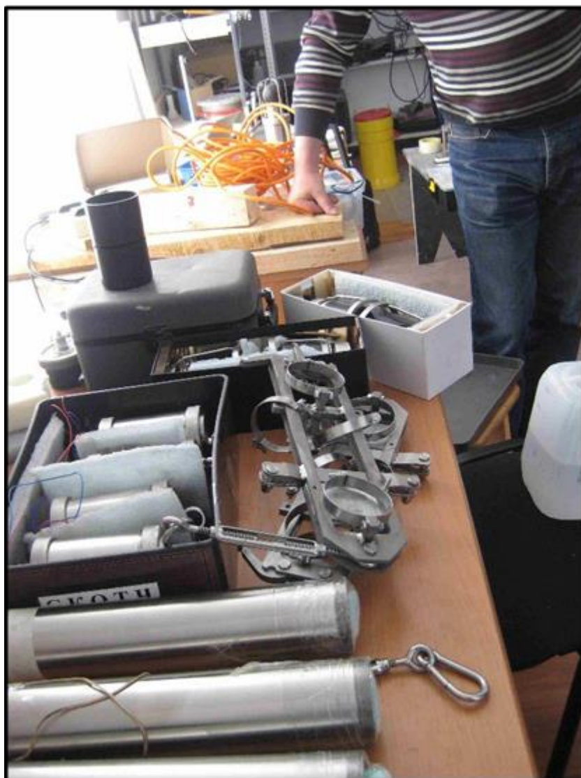
Figura 11: Componentes e estruturas do liberador acústico duplo para o Mooring.
