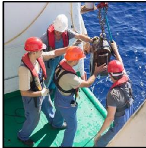
Figura 24: Retirada do pinger e do peso de 195Kg que mantinha a draga no fundo.
