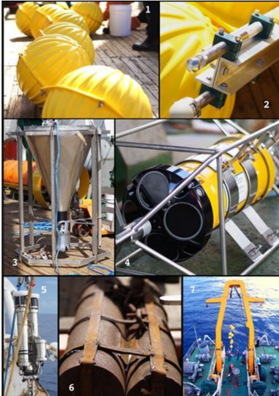
Figura 61: Componentes de um sistema de monitoramento Mooring. O sistema é composto por um conjunto de Boias (1), um sistema de localização visual (Flash) e por satélite que fornece sua localização a cada hora (2) uma trapa de sedimento (3), um ADCP (4), um sistema de liberação acústica dupla (5) e uma âncora (6). Todo o conjunto é colocado na água nesta sequencia (7).
