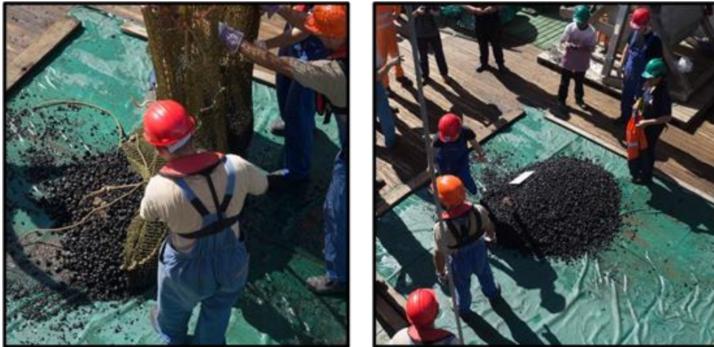
Figura 27: Liberação dos nódulos na lona para registro fotográfico e lavagem das amostras.
