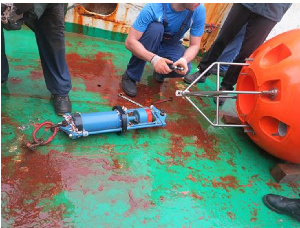
Figura 66: Perfilador/ADCP Aanderaa Seaguard do Mooring Alemão resgatado pela equipe da TOML na CCZ15 no Oceano Pacífico.
