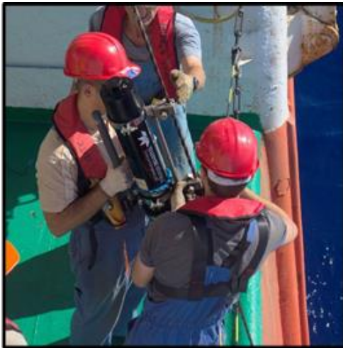
Figura 24: Retirada do pinger e do peso de 195Kg que mantinha a draga no fundo.
