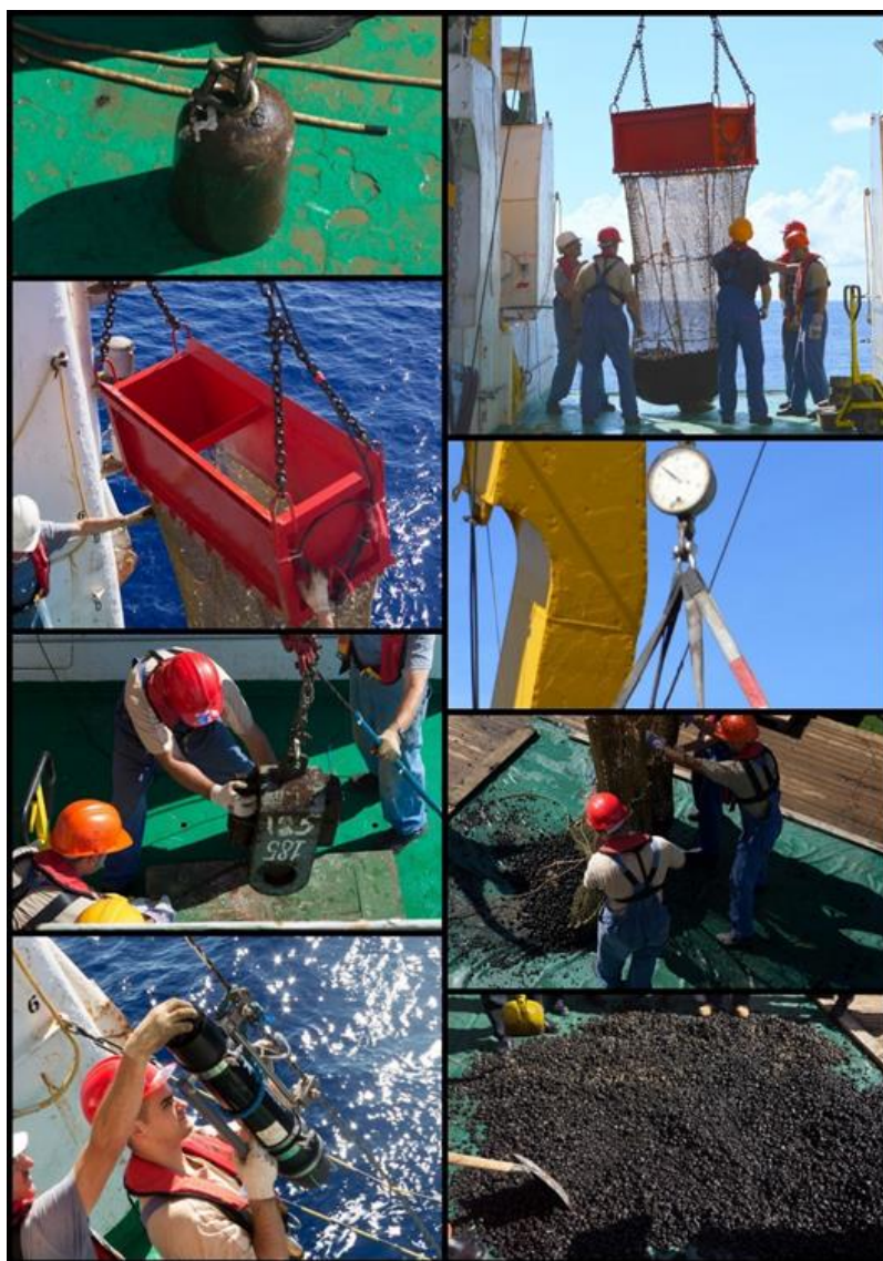
Figura 15: Etapas básicas para coleta de amostras de nódulos polimetálicos utilizando draga de arrasto.
