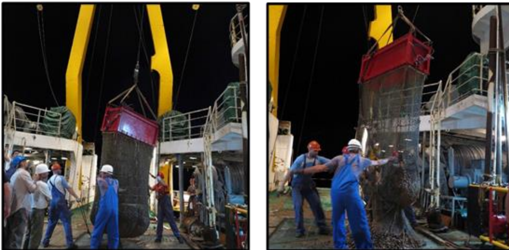
Figura 31: Pesagem dos nódulos e abertura da rede da draga sobre a lona.
