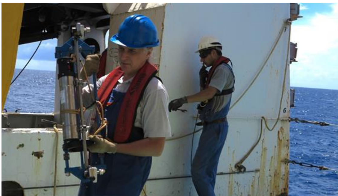
Figura 65: Modelo do Perfilador MAPR sendo retirado do cabo pelo qual os equipamentos eram lançados.
