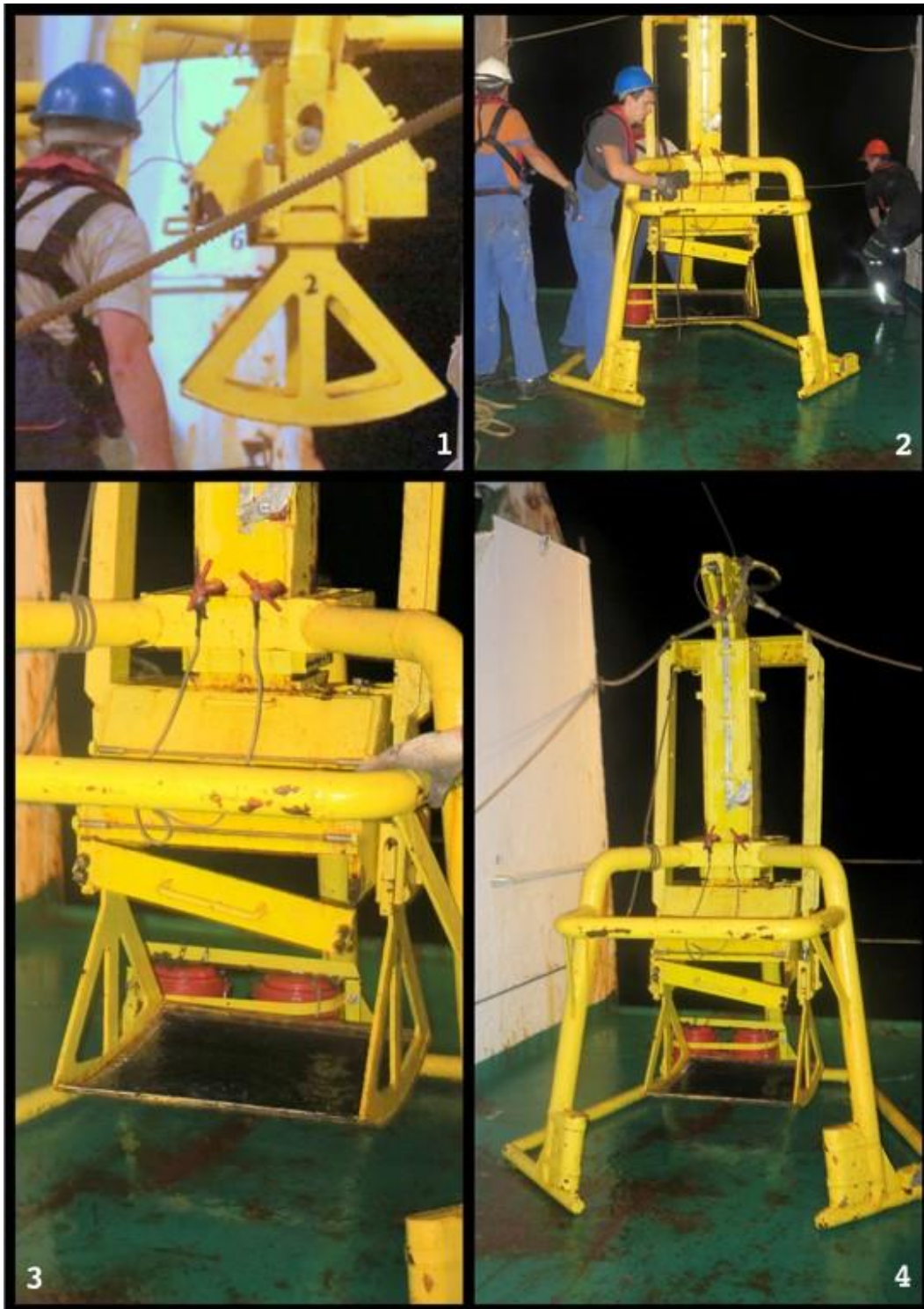
Figura 47: A figura mostra a estrutura do Box Corer da YMG sem a caixa. Por algum motivo a caixa se desprende e foi perdida. A equipe de deck rapidamente colocou no lugar outra caixa de um Box Corer sobressalente. Segundo o chefe da equipe de deck isso só tinha ocorrido uma vez no passado.
