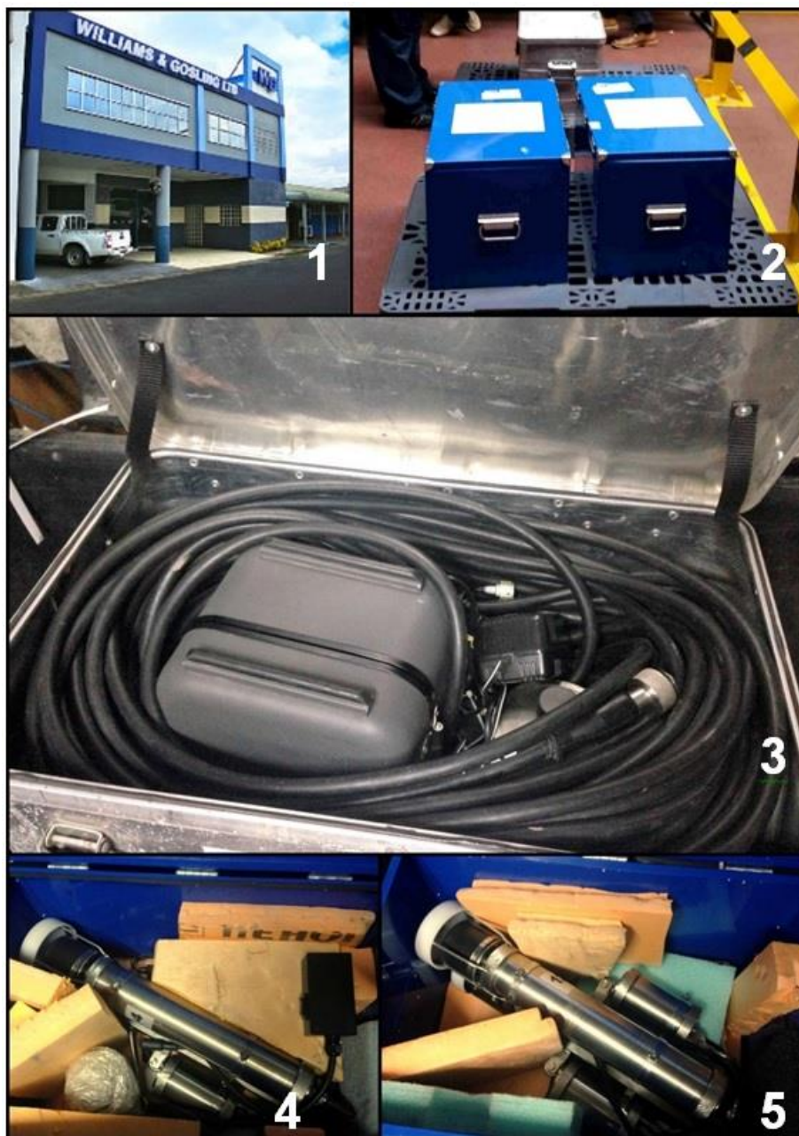
Figura 8: 1) WG transportadora em Nadi, Ilhas Fiji. 2) Caixa com os equipamentos do Mooring. 3) Codificador do sinal do liberador. 4) Liberador acústico Duplo (1) e 5) Liberador acústico Duplo (2)
