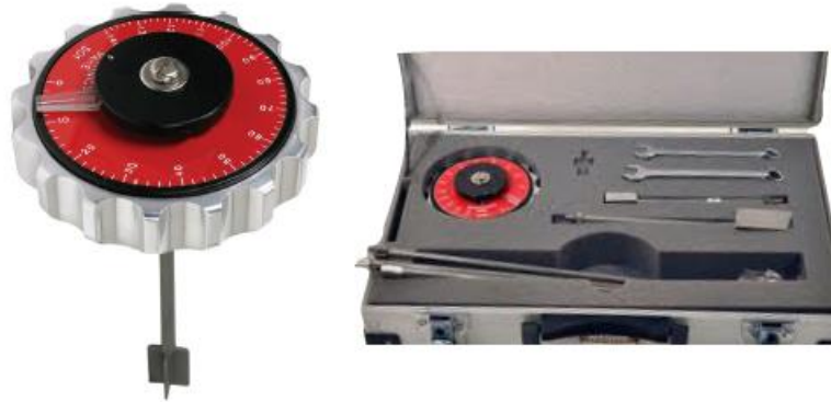
Figura 67: Vane-Shear é um equipamento que mede o grau de estresse do material coletado do substrato marinho através do Box Corer.
