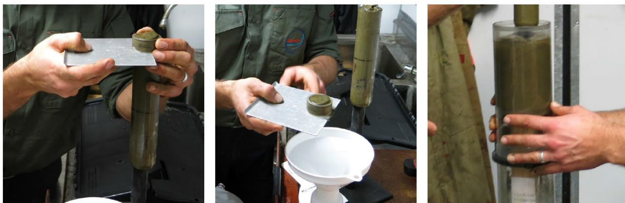
Figura 68: Processo de coleta do sedimento retirado do BC.
