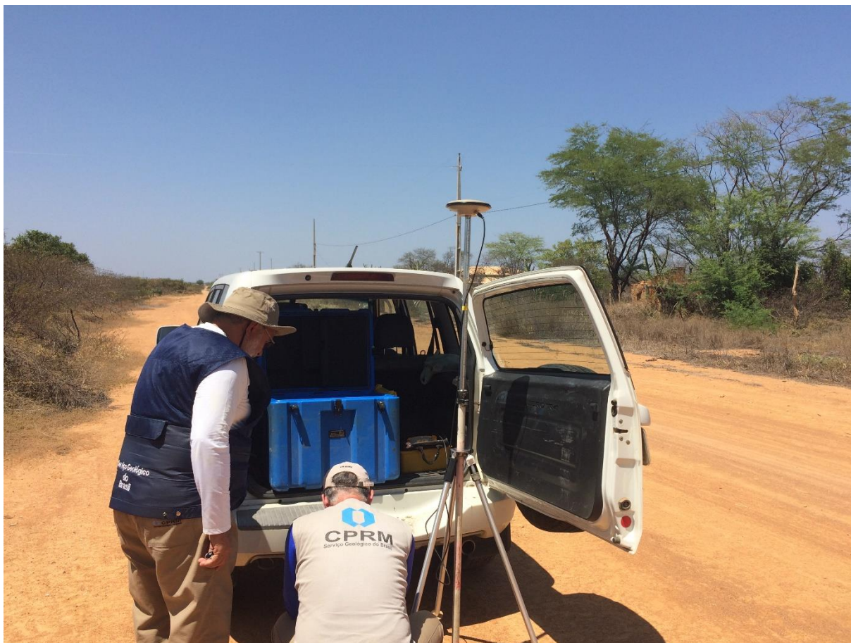
Montagem concomitante do Altimetro e do Gravímetro em área plana, sem movimentos de caminhões na rodovia que possam atrapalhar as medições.
