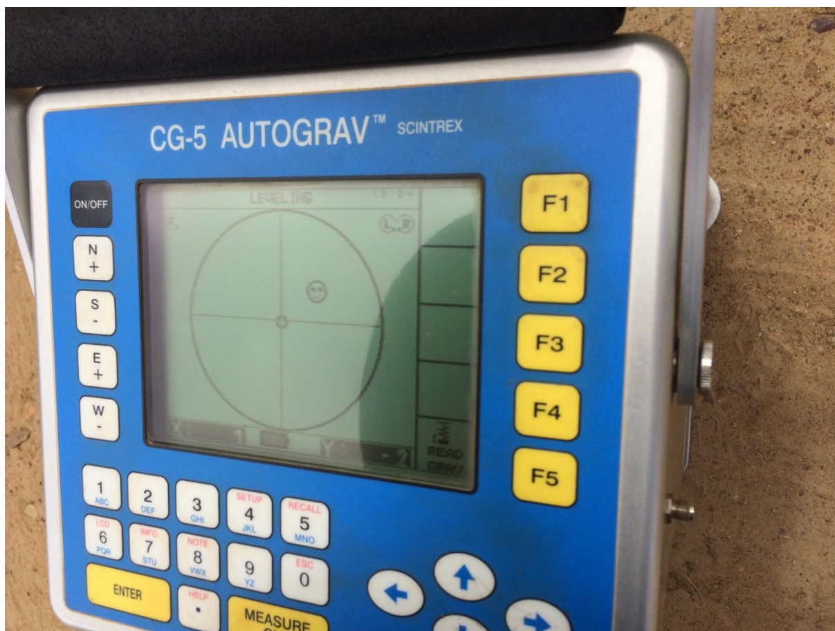
Gravímetro CG-5 Autograv™ Scintrex quando nivelado no solo através do tripé.
