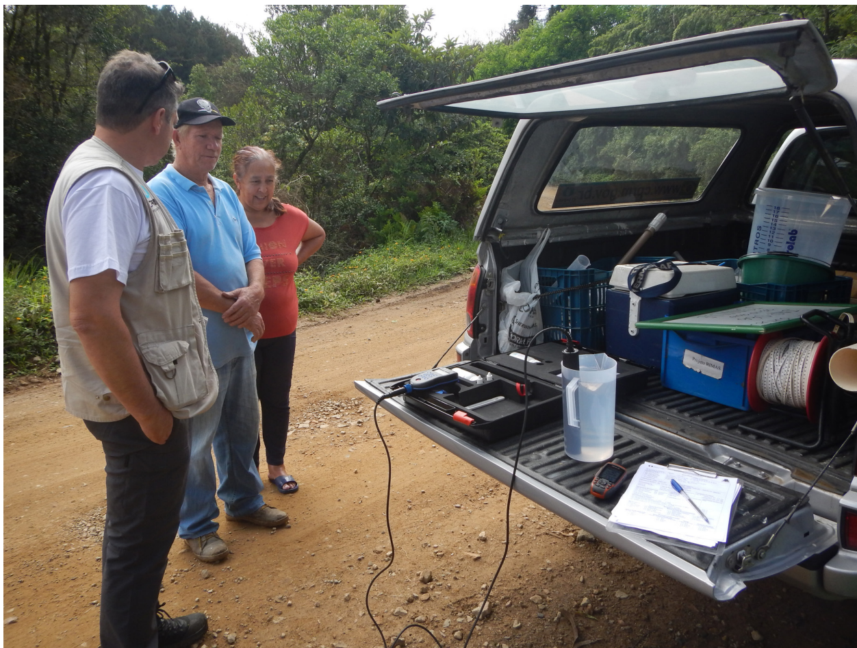
Figura 2.3 Medição in loco com sonda multiparamétrica das características físico-químicas das águas subterrâneas
