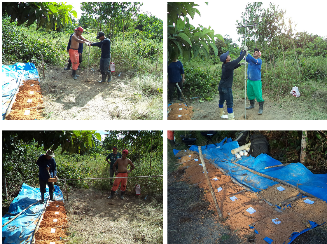
Figura 12 - Aspectos da perfuração e de todo o perfil de solo atravessado pelo furo PFG-04.
