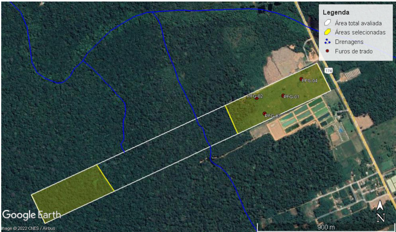
Figura 7 - Imagem de satélite de alta resolução (agosto/2019), com a situação da área avaliada (polígono em linhas brancas, com 41,5ha), das drenagens existentes em seu interior e entorno, e das áreas resultantes do detalhamento em campo (em transparência, com contorno amarelo, com dimensões de 13,5ha e 10ha), com a localização dos quatro furos de trado realizados. Fonte: Google Earth, 2022.
