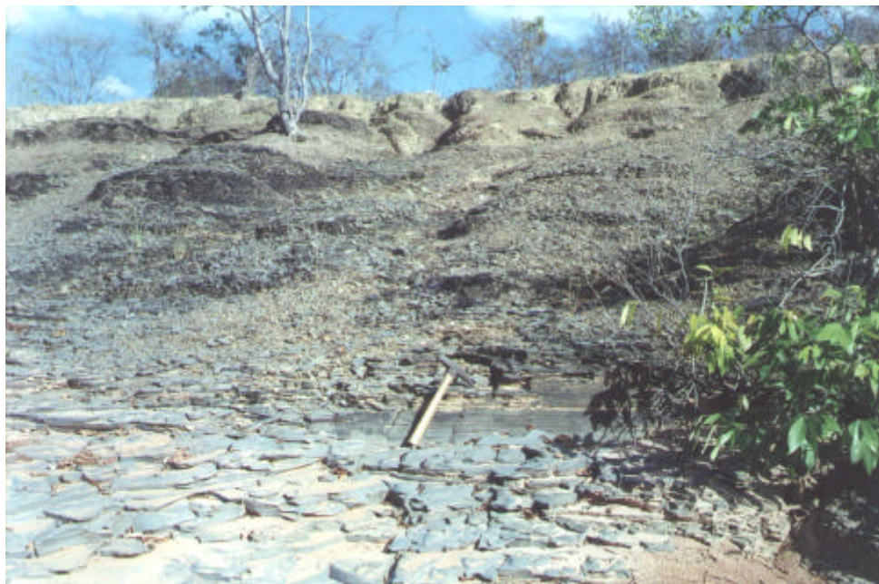
Foto 4 - Rocha metapelítica associada ao Subgrupo Paraopeba. Nota-se a gradação da rocha sã, para semi-alterada e alterada ("Toá"). Município de Ponto Chique.
