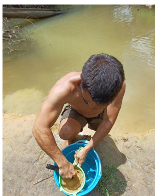
Foto 3 - Peneiramento de amostra de sedimento de corrente.
