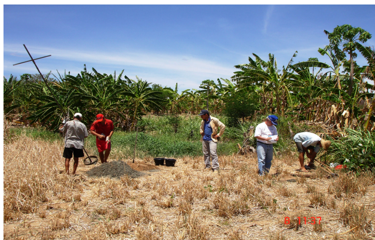
Figura 2.13 – prospecção com sondagens a trado para caracterização do perfil arenoso e espessura e largura aluvionar.
