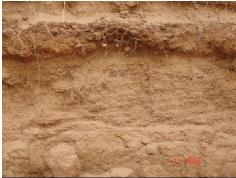
Figura 2.47 – Perfil do pacote aluvial passando do topo para a base, de camadas de areias quartzosas a material areno-siltoso contendo fragmentos de rocha.
