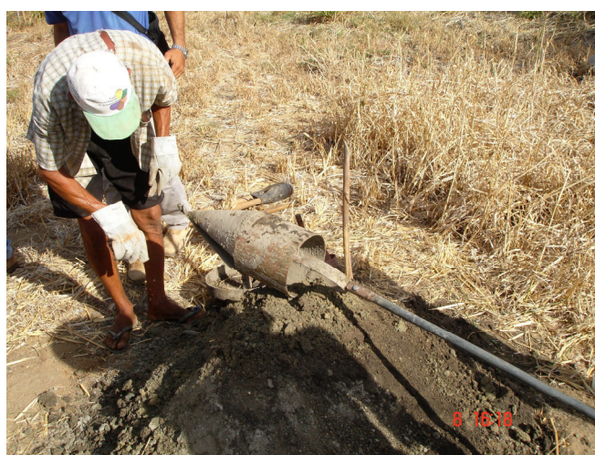
Figura 2.14 – prospecção com sondagens a trado para caracterização do perfil arenoso e espessura e largura aluvionar.
