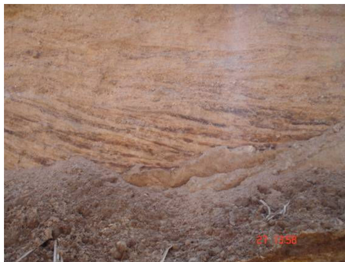
Figura 2.50 - Perfil mostrando do topo para a base a passagem de material fino, com estratificação cruzada, para material grosseiro contendo seixos.
