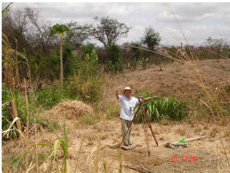
Figura 4.1 – nivelamento topográfico realizado em poços e eixo da barragem
