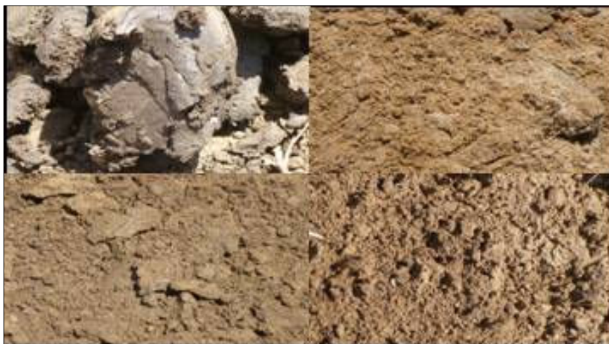
Figura 4.19 - Texturas silto-areno-argilosa e arenosa média a grossa, no perfil de um furo de prospecção do eixo da Barragem Subterrânea de Mãe d'Água – PB.
