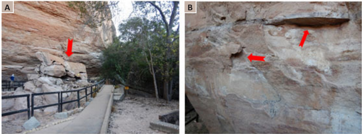
Figura 20 - Blocos instáveis (a) e cicatriz de queda de bloco e feições de deslocamento/escamação no arenito (b), configurando movimentação de massa e locais de risco aos visitantes. Foto: Autores, 2023.
