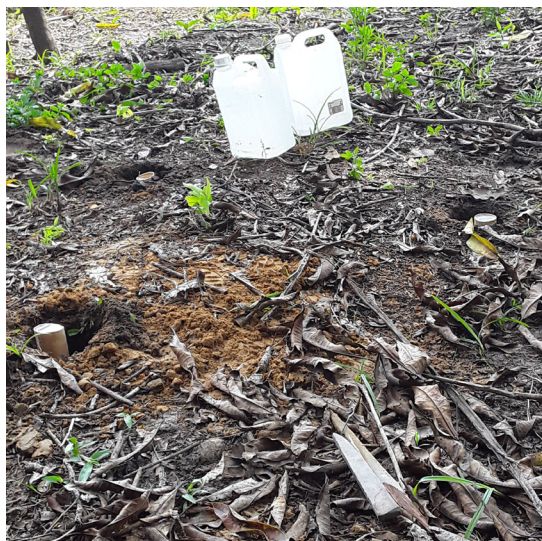
Figura 9 - Furos revestidos e preenchidos com água para execução do teste de infiltração no FT-02. Fonte: Elaborado pelos autores
