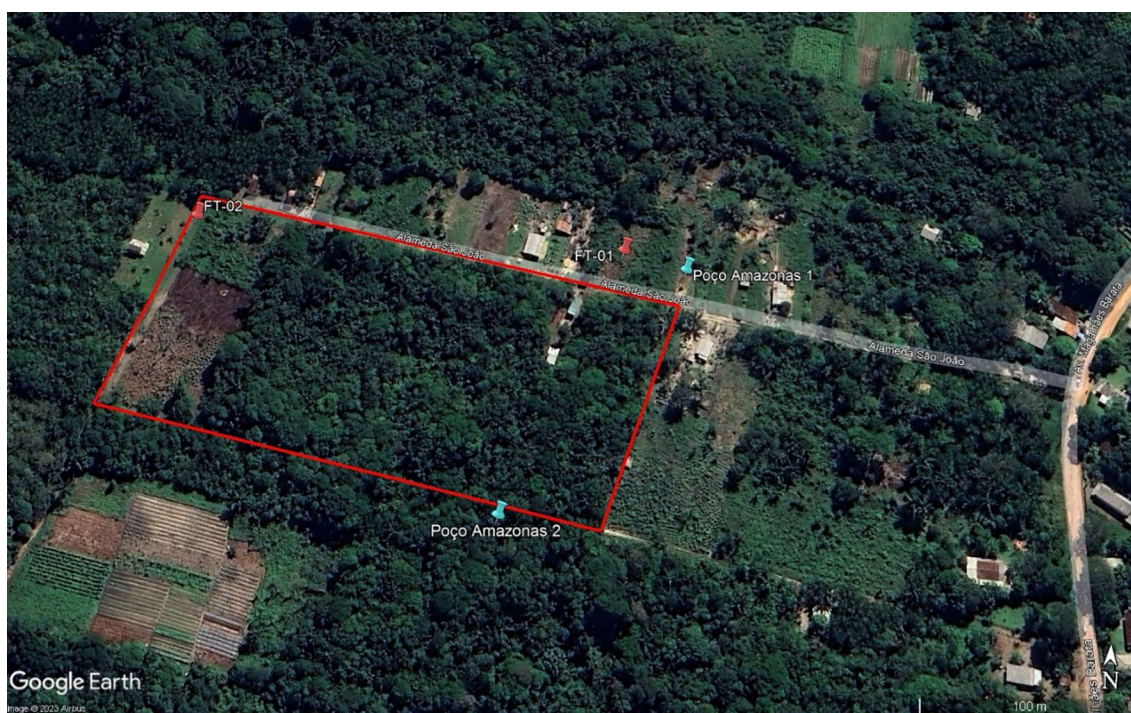
Figura 6 - Localização da área investigada com os furos de trado FT-01, FT-02 e os poços amazonas identificados. Fonte: Google Earth, 2023.
