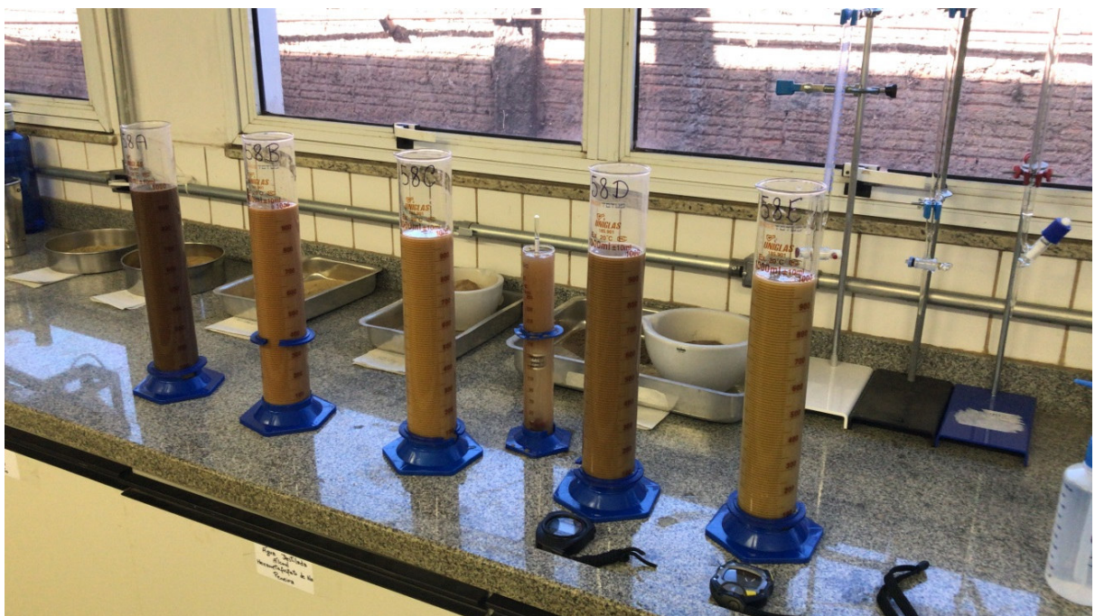
Figura 18 - Ensaio de granulometria com sedimentação, segundo ABNT NBR 7181 (2016).
