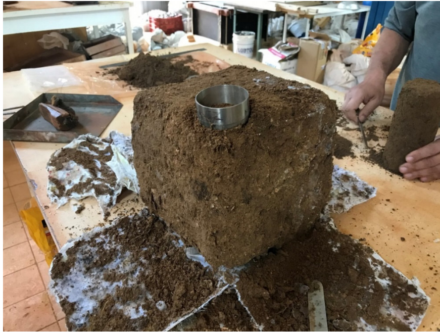
Figura 20 - Amostra indeformada sendo moldada para ensaios de cisalhamento direto e permeabilidade.
