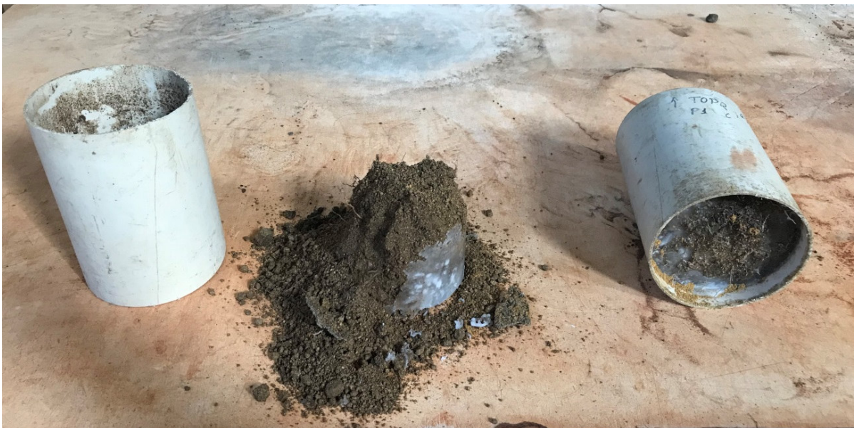
Figura 23 - Amostra indeformada do horizonte Cr2 da cicatriz de deslizamento (P1), colapsada após a retirada do tubo de PVC.
