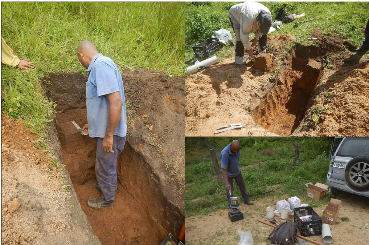
Figura 15 - Abertura da trincheira e coleta de amostras indeformadas, com a utilização de parafina (Fotos: autor, 2022).
