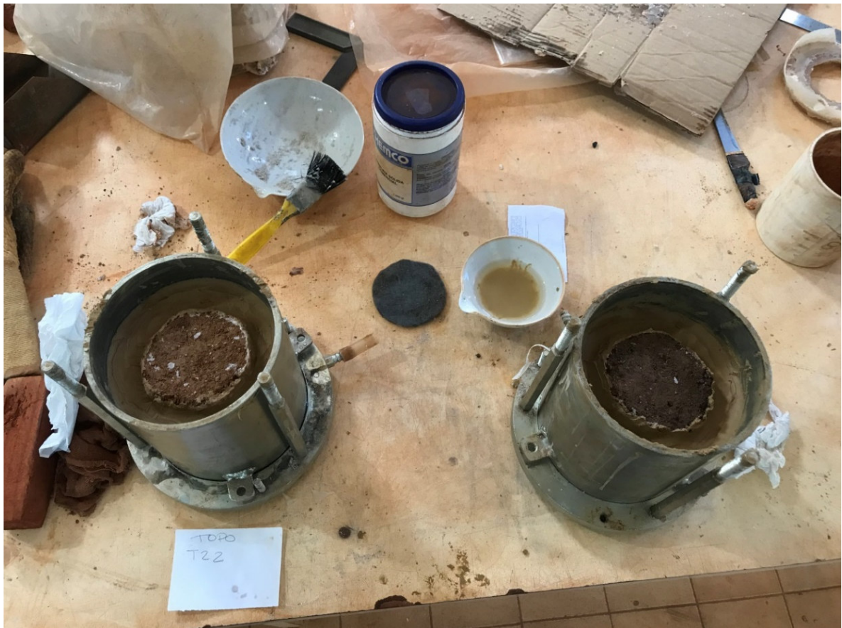
Figura 22 - Corpo de prova em preparação para ensaio de permeabilidade.
