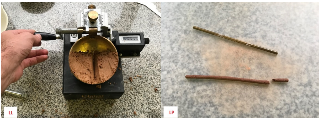
Figura 19 - Realização dos ensaios de LL e LP.
