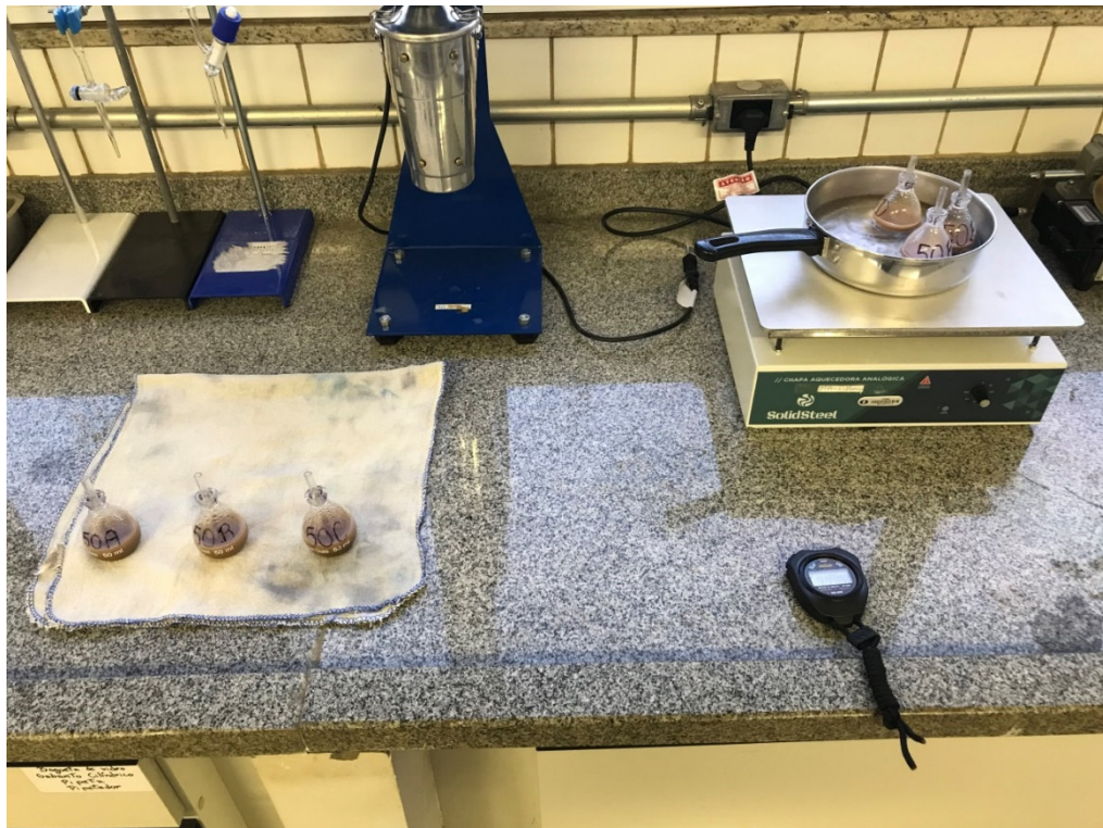
Figura 17 - Determinação da densidade real grãos, através do método do picnômetro.
