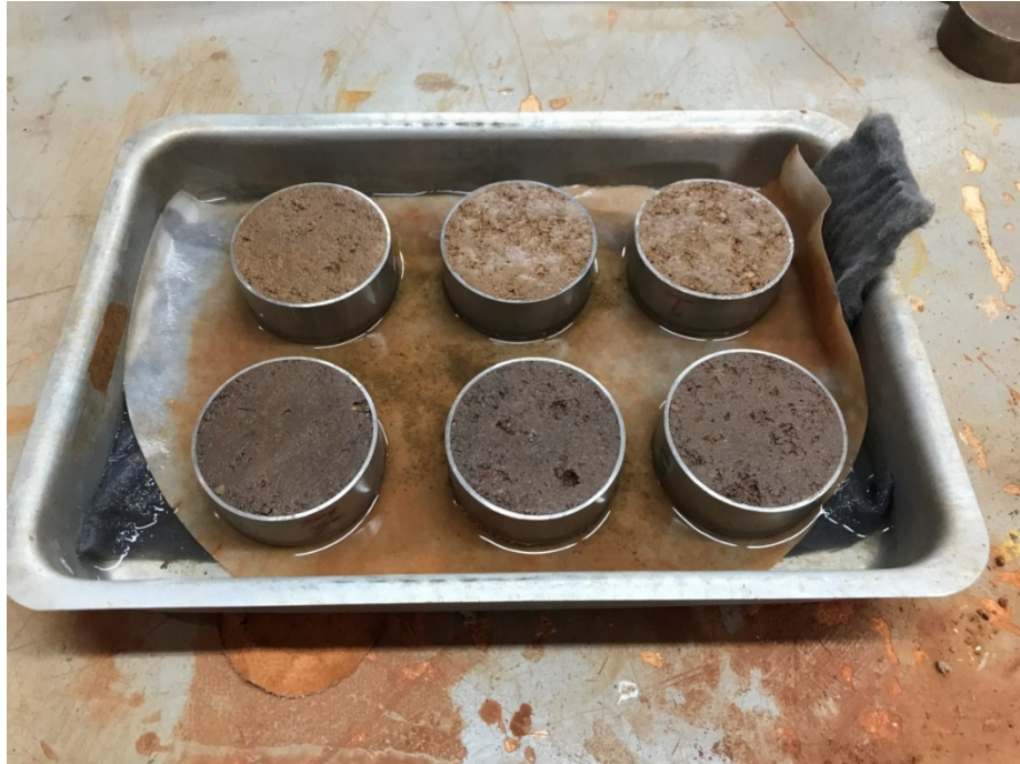
Figura 21 - Corpos de prova em processo de saturação para ensaios de cisalhamento direto.
