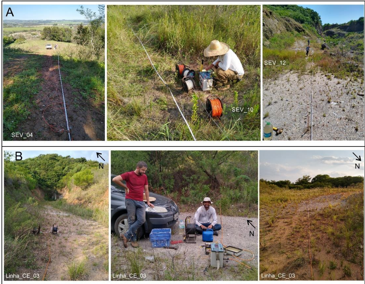
Figura 11 - Aquisição de dados de campo: Quadro A) SEVs 04 e 12; Quadro B) Aquisição de dados da linha 03 de Caminhamento Elétrico. Fonte: Autor (2023).
