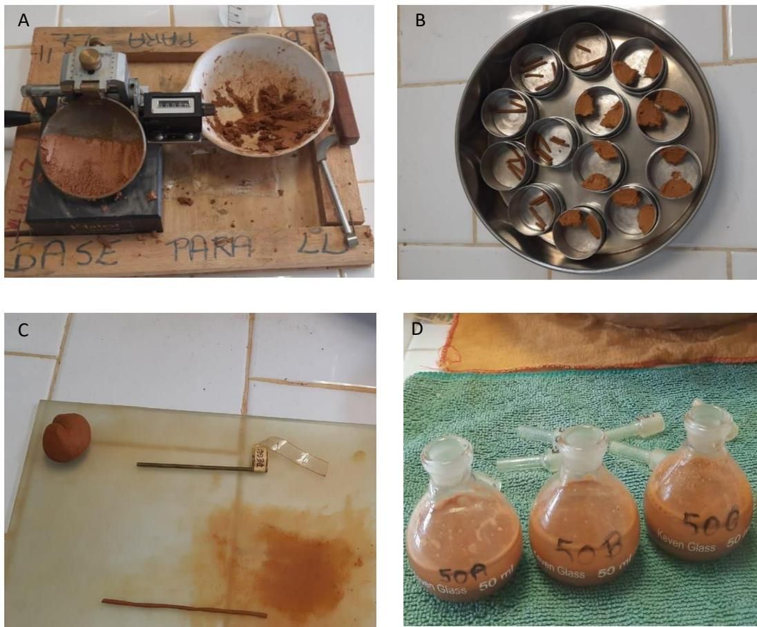
Figura 7. Alguns ensaios: (A) Limite de Liquidez, (B) Amostras de Limites de Liquidez e plasticidade indo para estufa, (C) Limite de Plasticidade e (D) Ensaio de Densidade Real dos grãos
