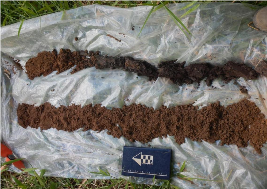
Figura 10- Amostra 28A: silte orgânico de baixa compressibilidade (OL)
