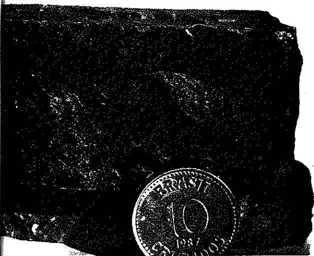
Foto V.03 - Tufos lapilíticos com fragmentos imersos em mesóstase granular vulcanogênica
