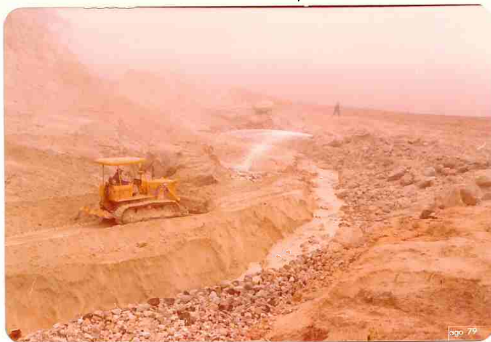
Foto 30 - Frente de desmonte do porto-de-areia Lara, situado no bairro do Sertãozinho, em Mauá. Em primeiro plano nota-se a cascalheira resultante da desintegração do material.
