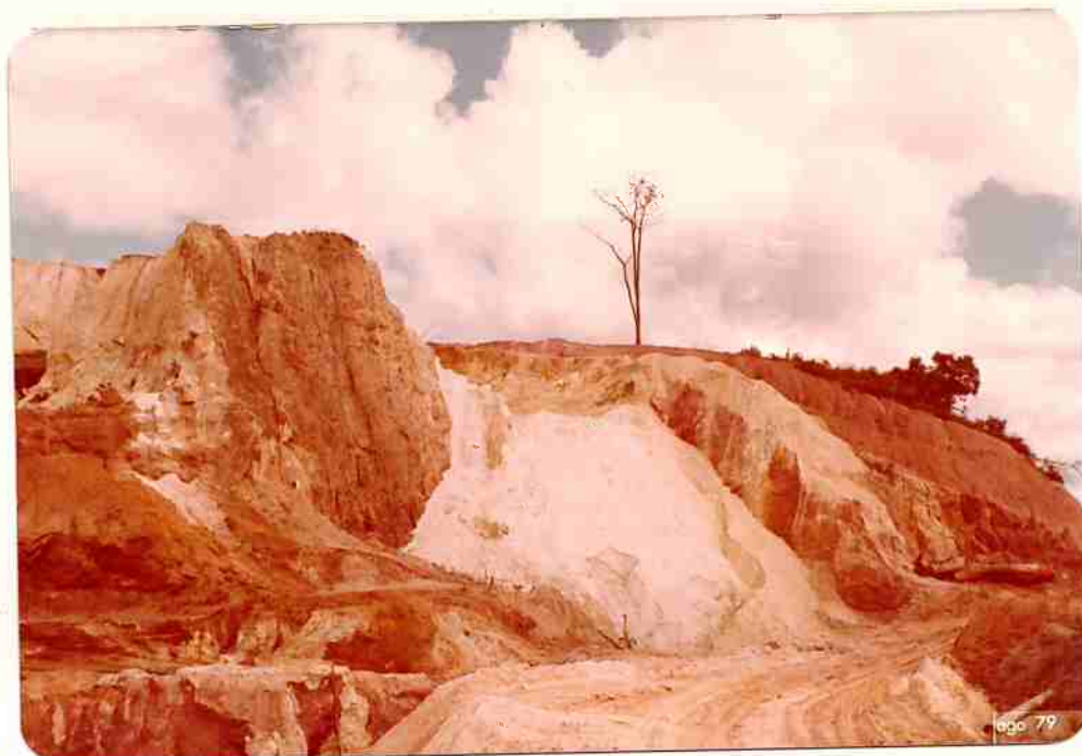
Foto 38 - Detalhe da frente de lavra de caulim da Mineração MM Ltda., no bairro do Penteado, em Embu-Guaçu. Destaque-se a pos sança do corpo caulínico.
