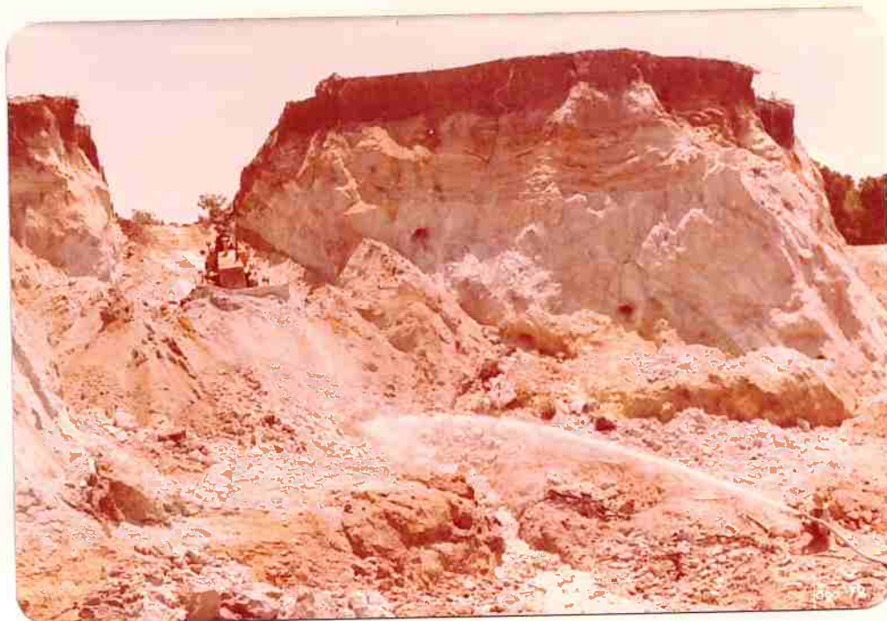
Foto 32 - Porto-de-areia Rio Branco, situado no bairro do Curucutu (São Bernardo do Campo). Observe-se a pequena cobertura sedimentar sobre rocha granitóide decomposta, exploradas por desmonte mecânico e hidráulico conjugados.
