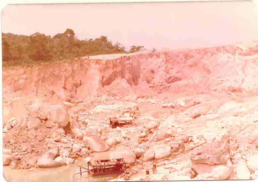
Foto 29 - Frente de lavra do porto-de-areia Olifar, no bairro do Bororé, São Paulo. Notar a grande quantidade de matações remanescentes da lavra.
