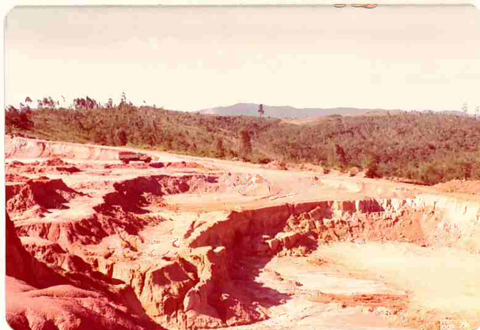
Foto 46 - Extração de argila para cerâmica vermelha no bairro do Oropó, em Mogi das Cruzes.
