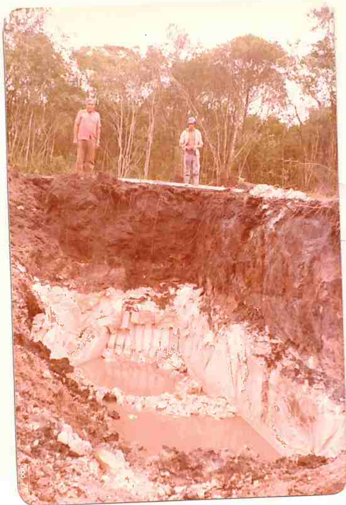
Foto 37 - Detalhe de uma jazida de argila, situada a sul de Biritiba Mirim, mostrando espesso capeamento de solo turfoso.
