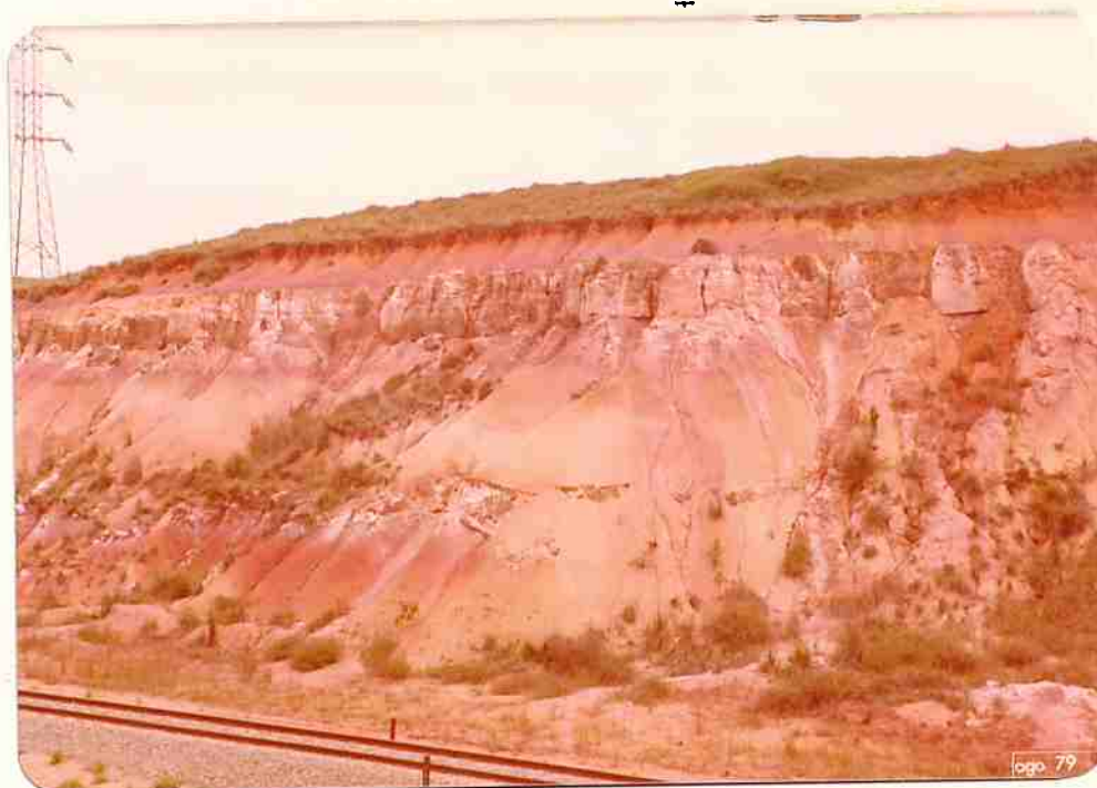
Foto 47 - Ocorrência de argilas de cores variegadas no bairro São Bento, em Mogi das Cruzes, apresentando intercalações de níveis arenosos.
