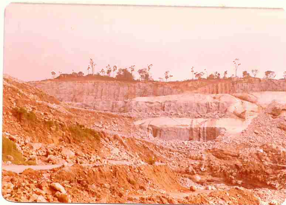
Foto 5 - Aspecto geral de uma das frentes de lavra da Pedreira Itapeti, mostrando três bancadas, a mais alta com cerca de 30 m.
