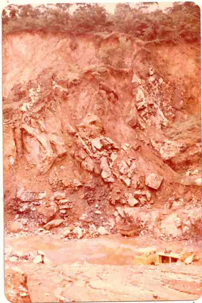
Foto 62 - Aspecto de uma frente de lavra de calcário da Mineração Lolli, onde se observa a grande espessura de solo e rocha incoerentes.
