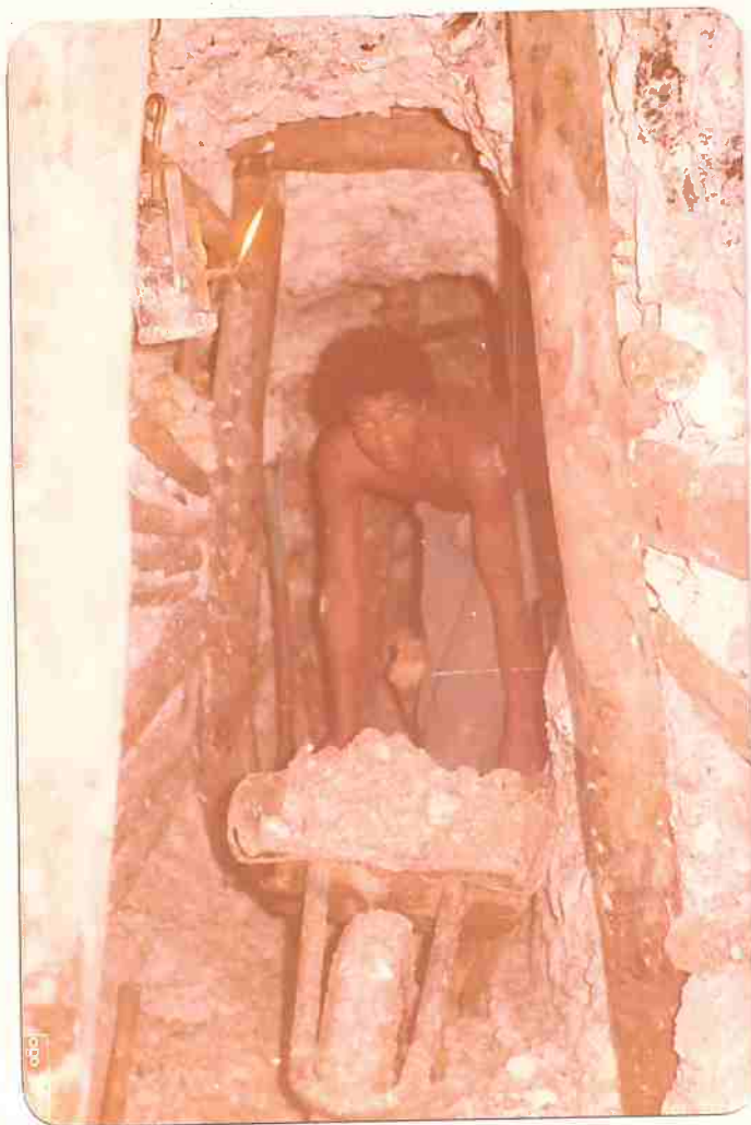
Foto 74 - Aspecto de um garimpo de mica no bairro do Penteado , em Embu-Guaçu. A lavra é subterrânea e as galerias são abertas no corpo pegmatítico, desperdiçando-se grande quantidade de caulim.
