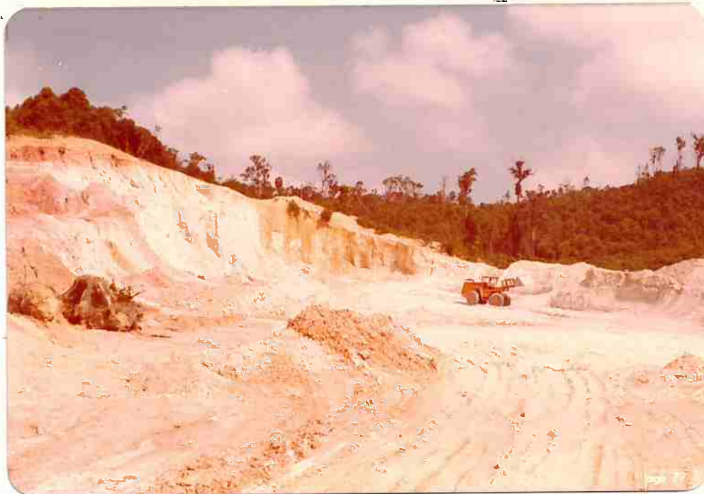
Foto 39 - Frente de lavra da jazida de caulim da Sociedade Caulinita. Note-se a possança do corpo e a extração efetuada por pá carregadeira. Bairro do Penteado, Embu-Guaçu.
