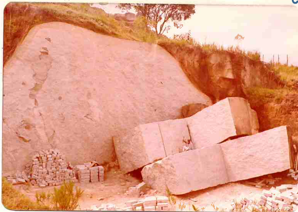
Foto 66 - Exploração de granito para confecção de pedras para cantaria e paralelepípedos, nas proximidades da cidade de Mogi das Cruzes.
