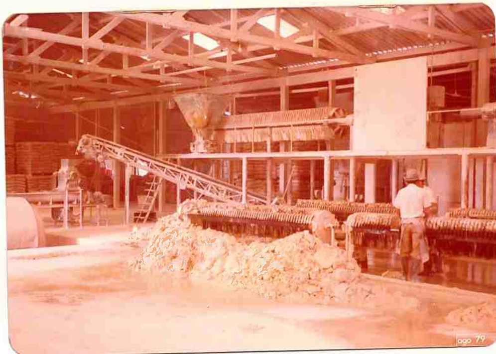
Foto 42 - Mineração Horii. Detalhe das instalações de beneficiamento (filtros-prensa, secagem e ensacamento).
