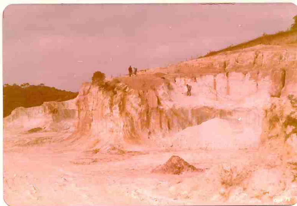
Foto 43 - Jazida de caulim da Mineração Joseph Nigri, em Palhereiros, operada por pá carregadeira. Note-se a possança do corpo caulínico.
