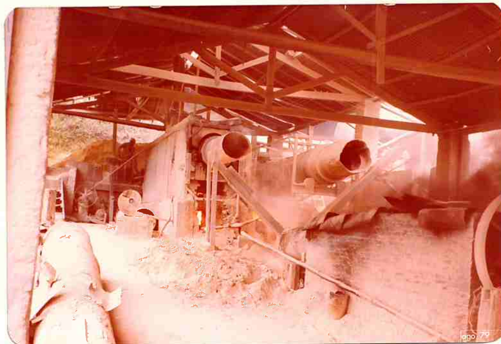
Foto 40 - Aspecto dos fornos para secagem de caulim da Mineração Jompe, no bairro Penteado (Embu-Guaçu).
