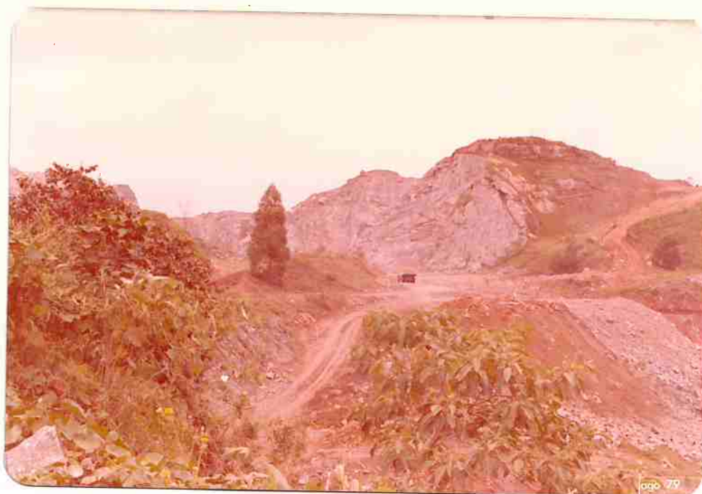
Foto 6 - Vista geral da frente de lavra da Pedreira Nassau, em Santa Isabel, onde se observa a inexistência de capotamento de solo.
