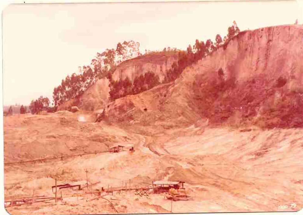
Foto 31 - Aspecto de uma lavra de areia, a partir de rocha migmatítica, no município de Embu.
