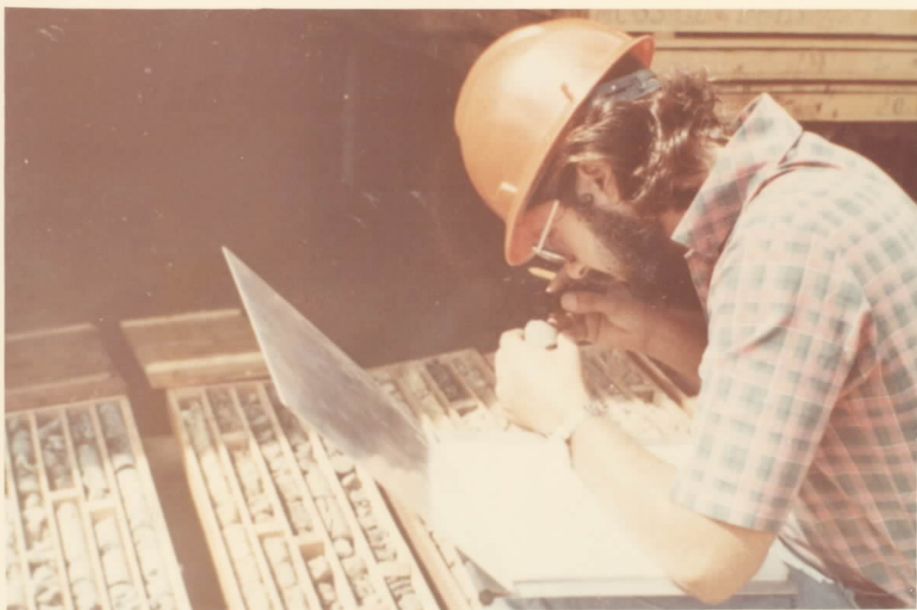
FOTO Nº 16 - Descrição de testemunhos de sondagem.
