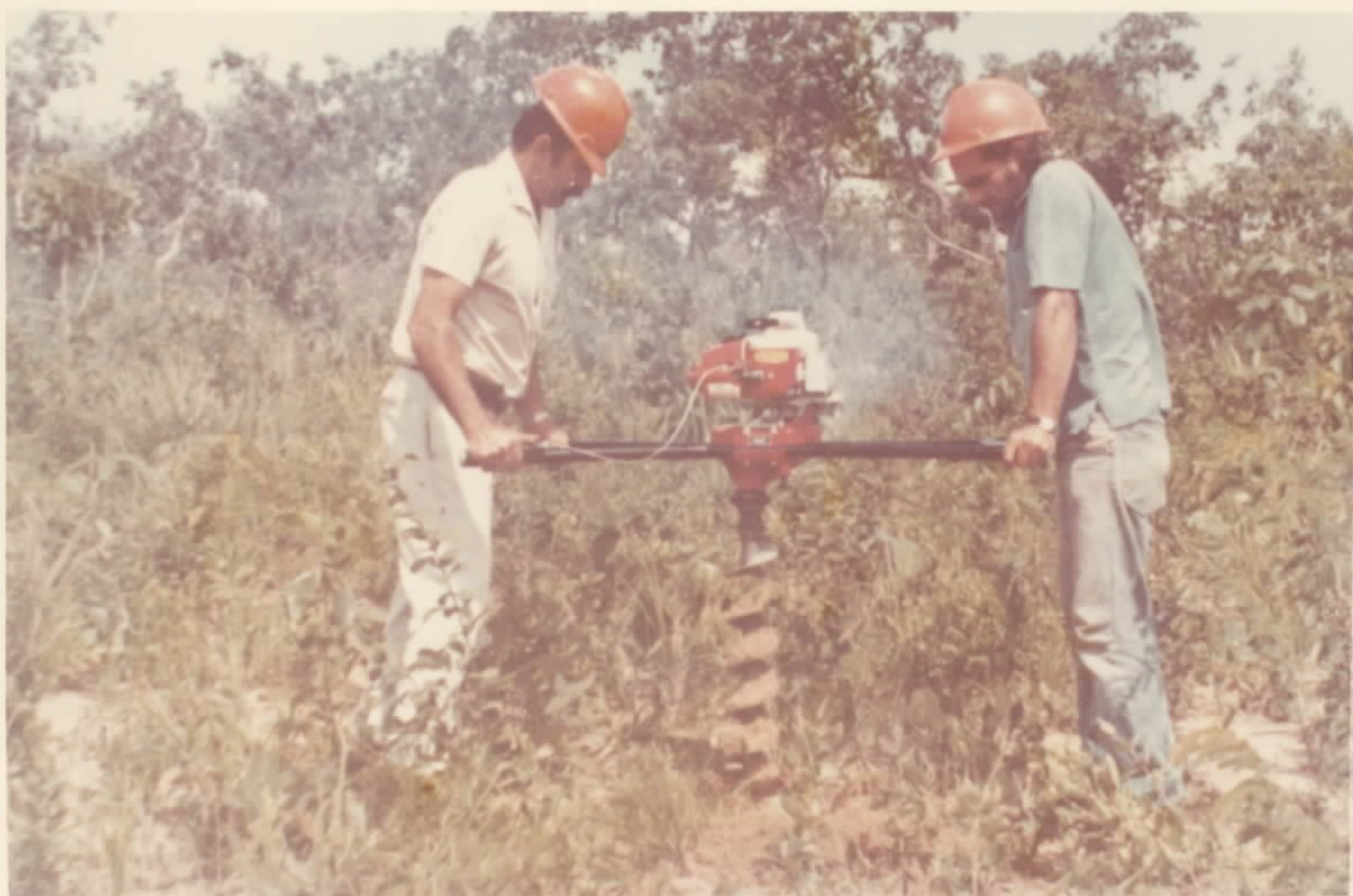
FOTO Nº 08 - Prospecção geoquímica com auxílio de trado motorizado.
