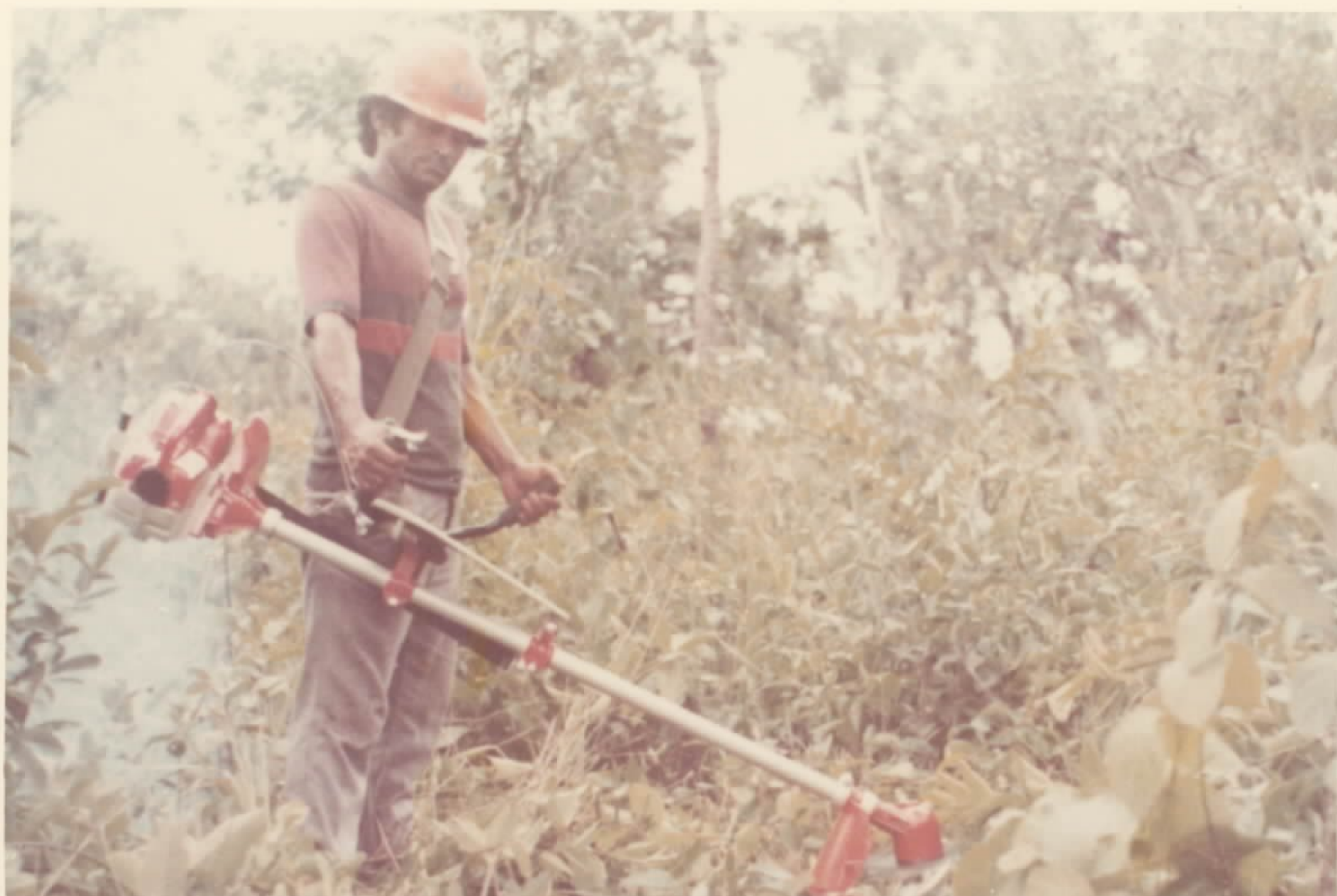
FOTO Nº 07 - Abertura de picadas com auxílio de equipamento motorizado.
