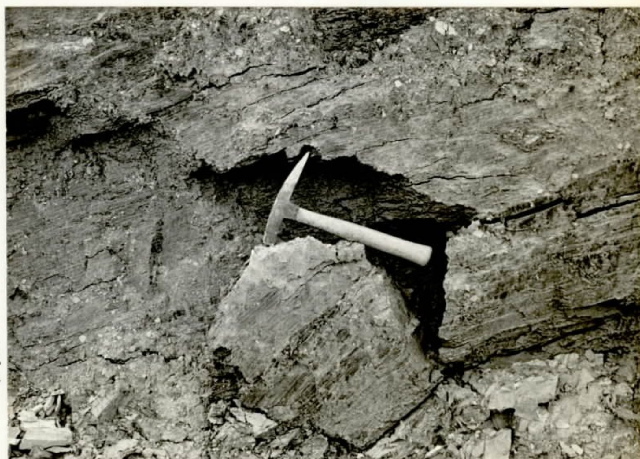
Foto 05b- Detalhe da foto anterior. Exposição de filitos decompostos, com mergulhos predominantemente para NE.
