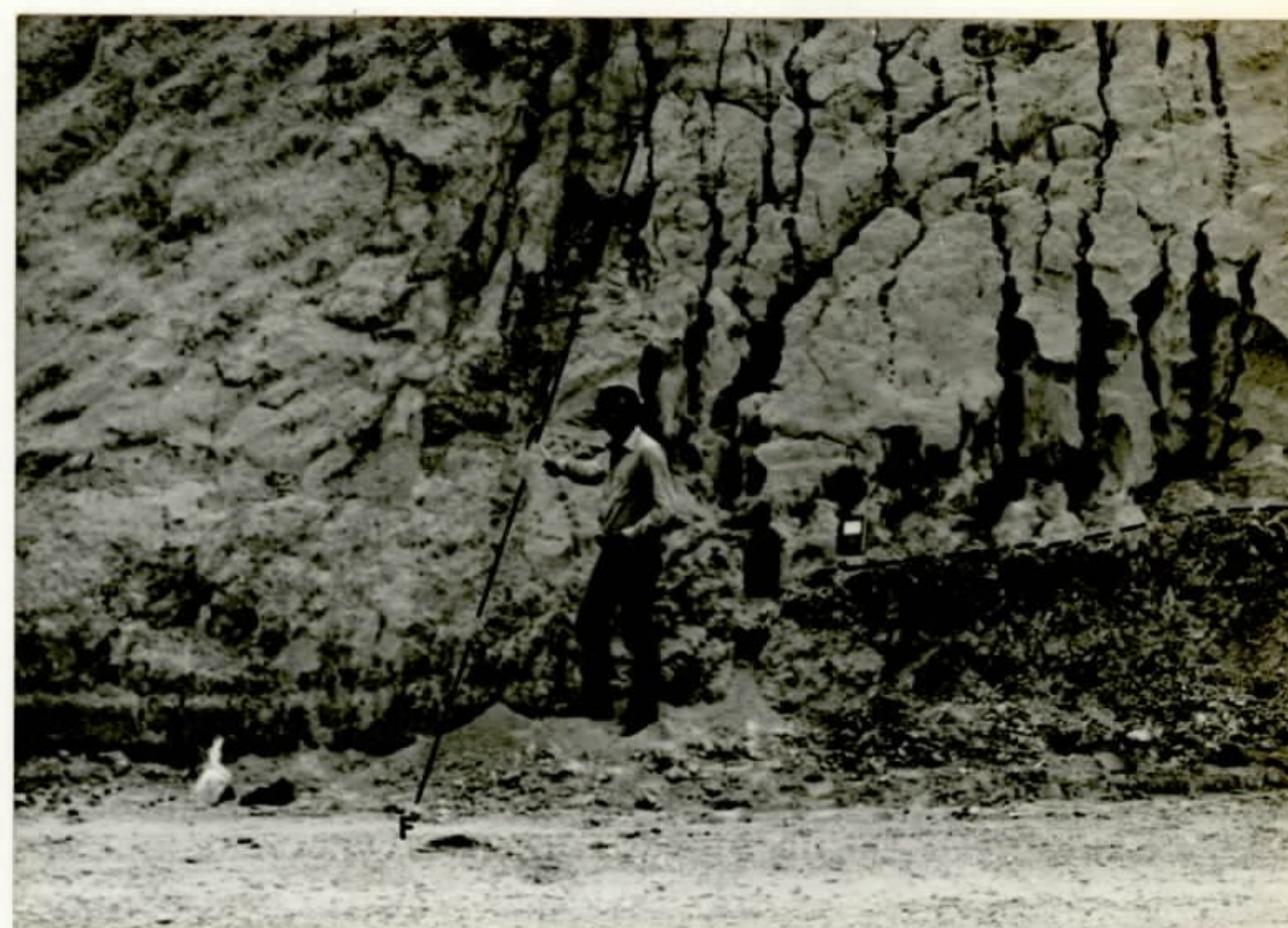
Foto 12 -- Corte na estrada destacando falhamento T de gravidade afetando o conjunto litológico folhelho-arenito da Formação Pedra de Fogo, no Km 13 do trecho Marabá-Altamira.
