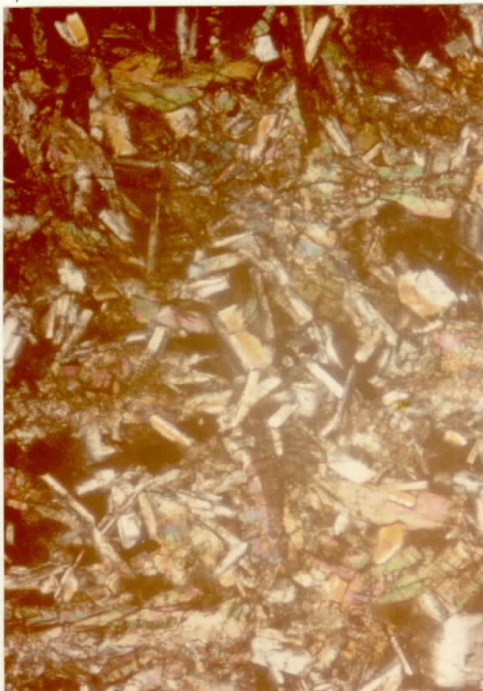
Foto 27 - Diabásio (NX). T extura ofítica típica. Augita em g eminação do tipo Carlsbad, algo zonada e rara ur alitização. Plagioclásio do tipo andesina-labradorita, com g eminação polissintética e forte alteração à seri cita.
