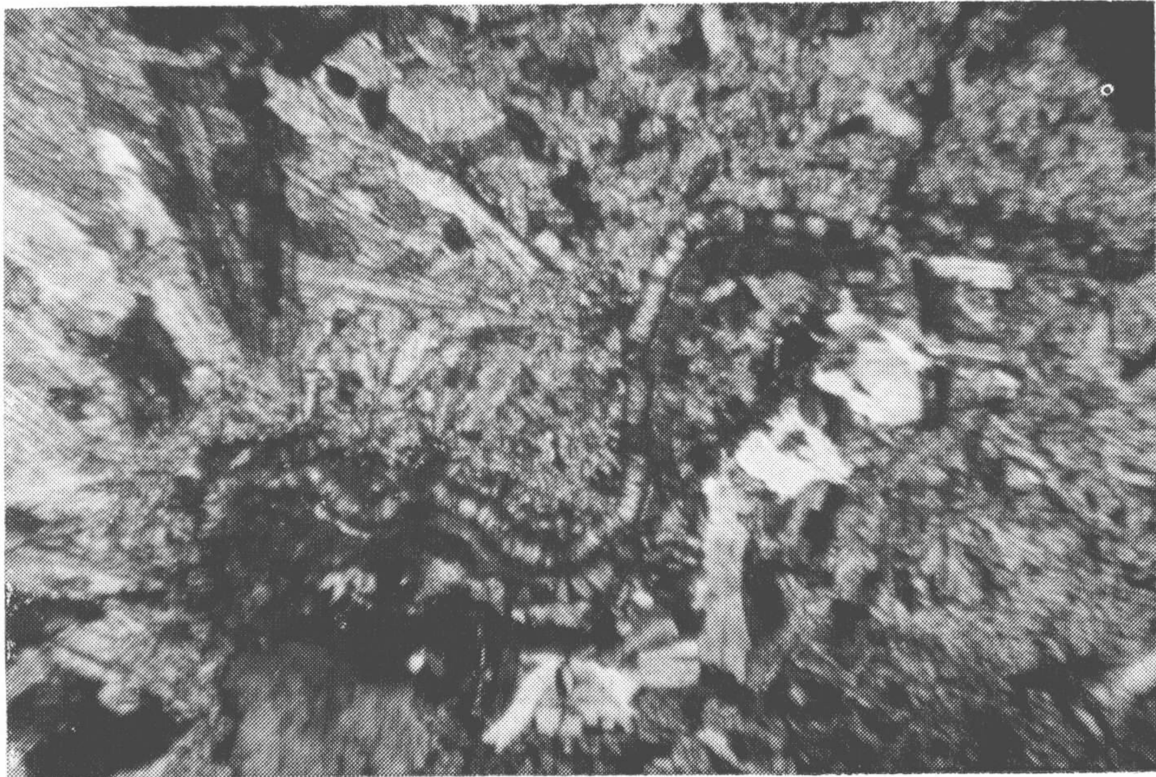
Foto 23 — Albita basalto vitrofírico e amigdalóide, aflorante no povoado Jaibarras. Vesículas preenchidas por clorita, epidoto e plagioclásio sódico. Foto com NX.
