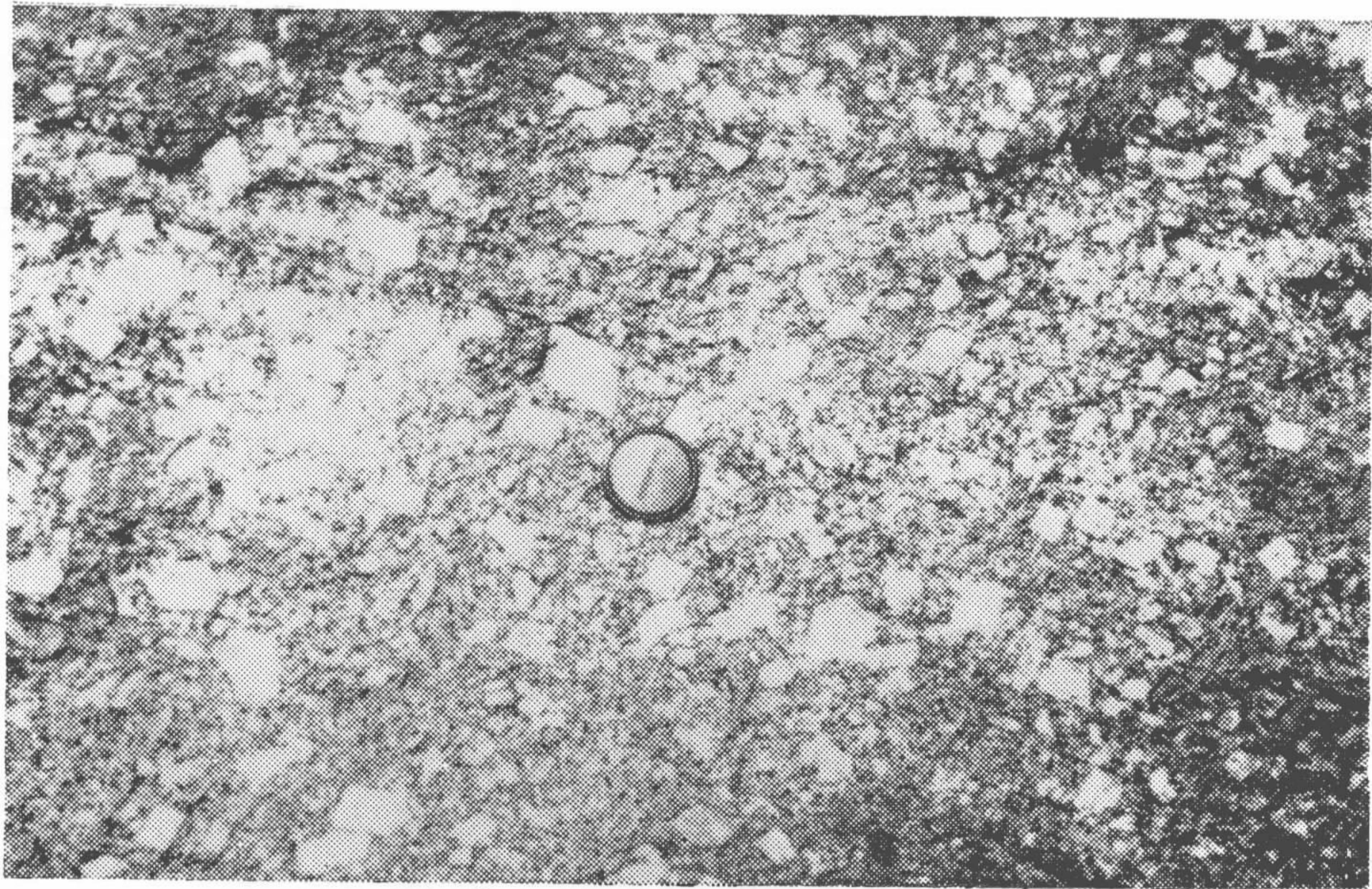
Foto 2 — Aspecto típico do granito porfiróide tipo Chaval. Notar os cristais hipidiomórficos de feldspato imersos em matriz granoblástica.
