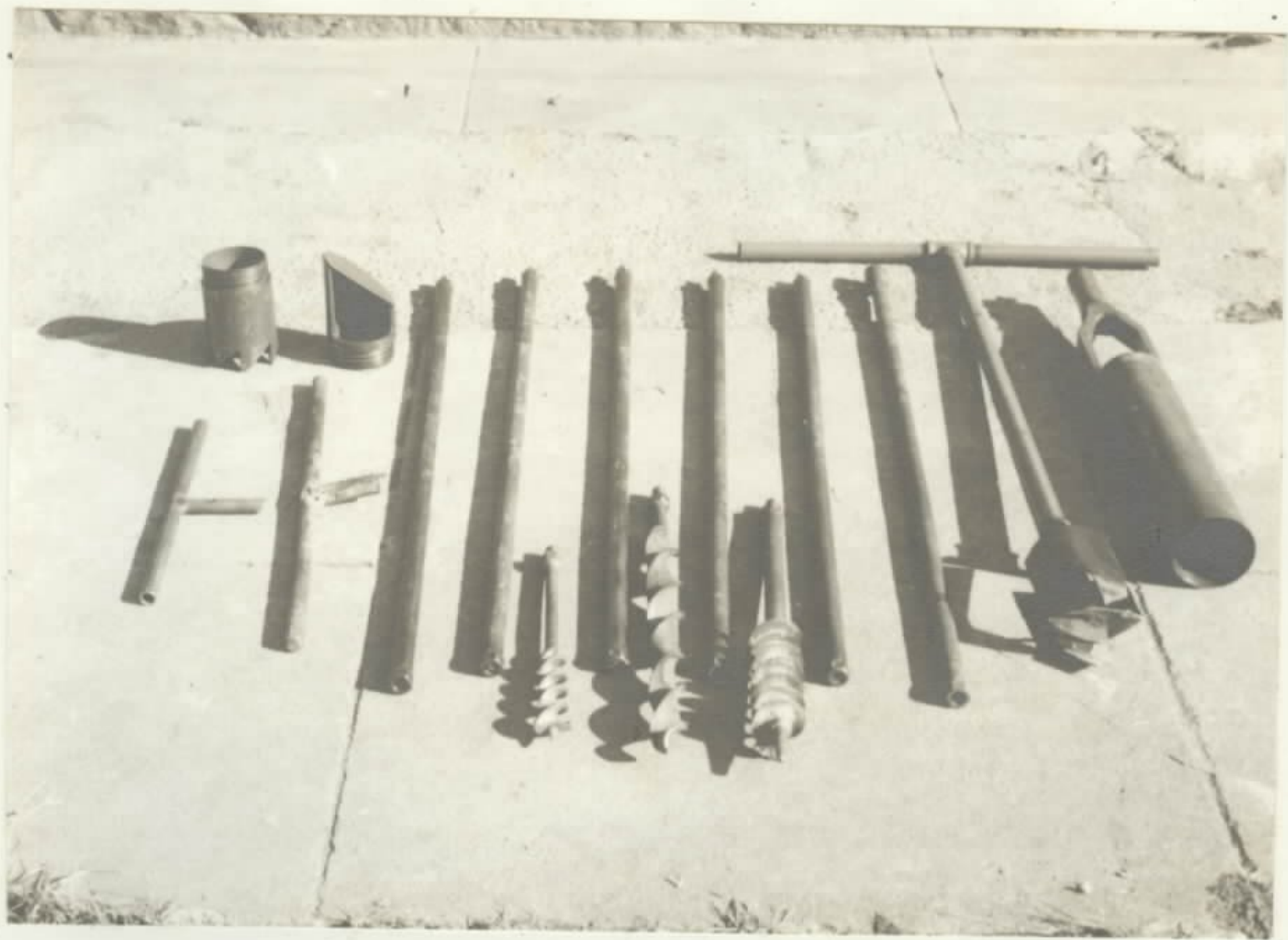
Foto 1 - Componentes dos trados helicoidais e amostrador
