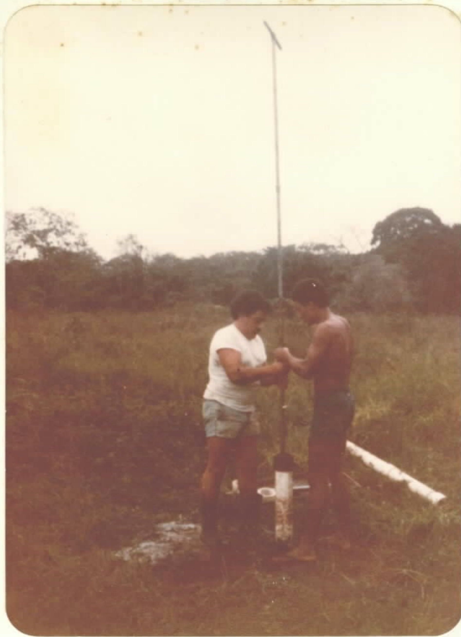
FOTO 1 - Sondagem com trado agrícola convencional, utilizando-se revestimento de superfície de tubo PVC.
