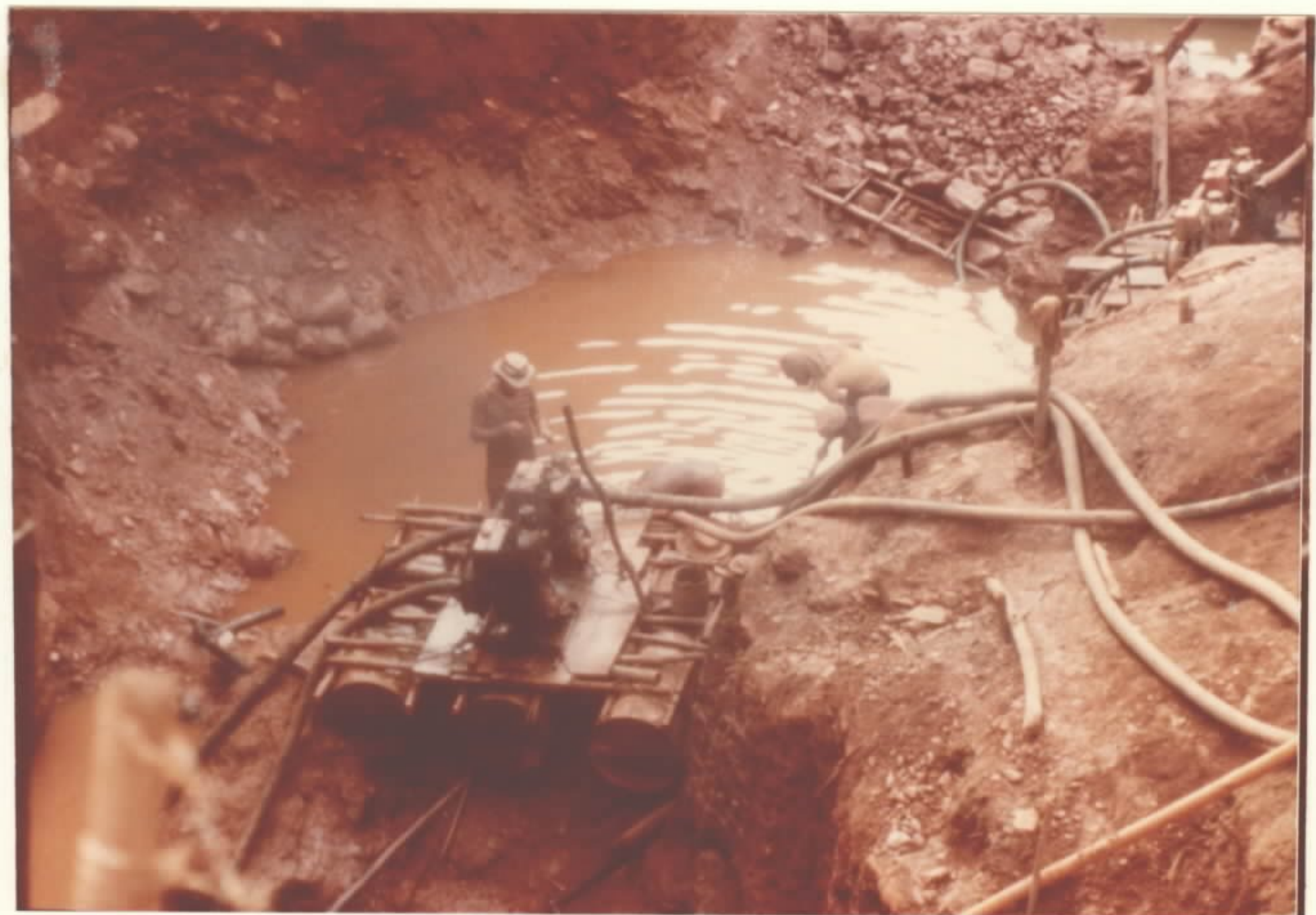
FOTO 10 - Processo de desmonte hidráulico acoplado a transporte do min er rio (chupadeiras).
