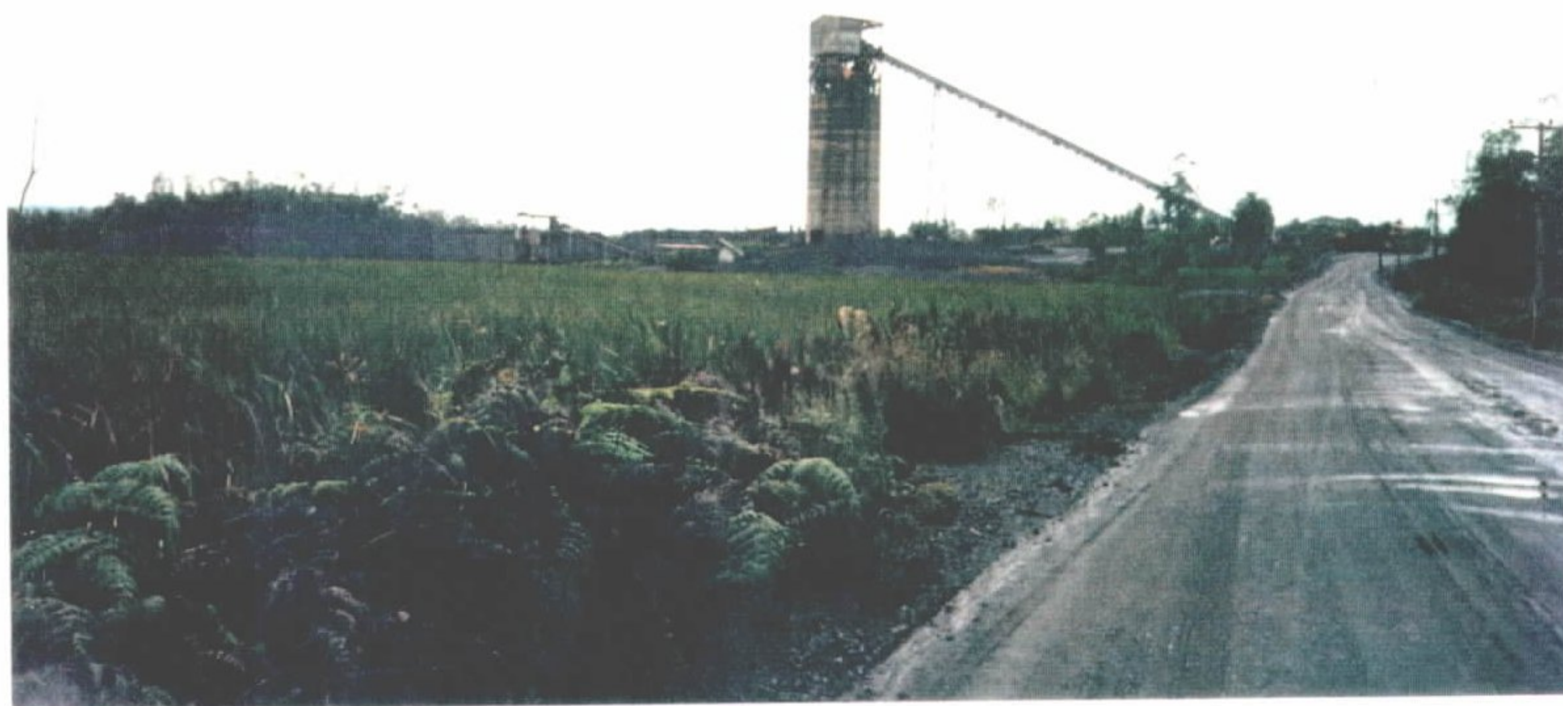
Foto 4 - Transporte de carvão através de correia transportadora do subsolo para os locais de beneficiamento. Localidade de Sangão.
