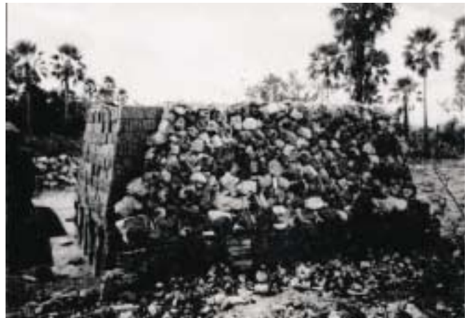
Foto 21 – Aspecto rudimentar do beneficiamento de argila aluvionar para fabricação de tijolo, de uso na construção civil. Poões, Campo Maior-PI. Afloramento JA-210.
