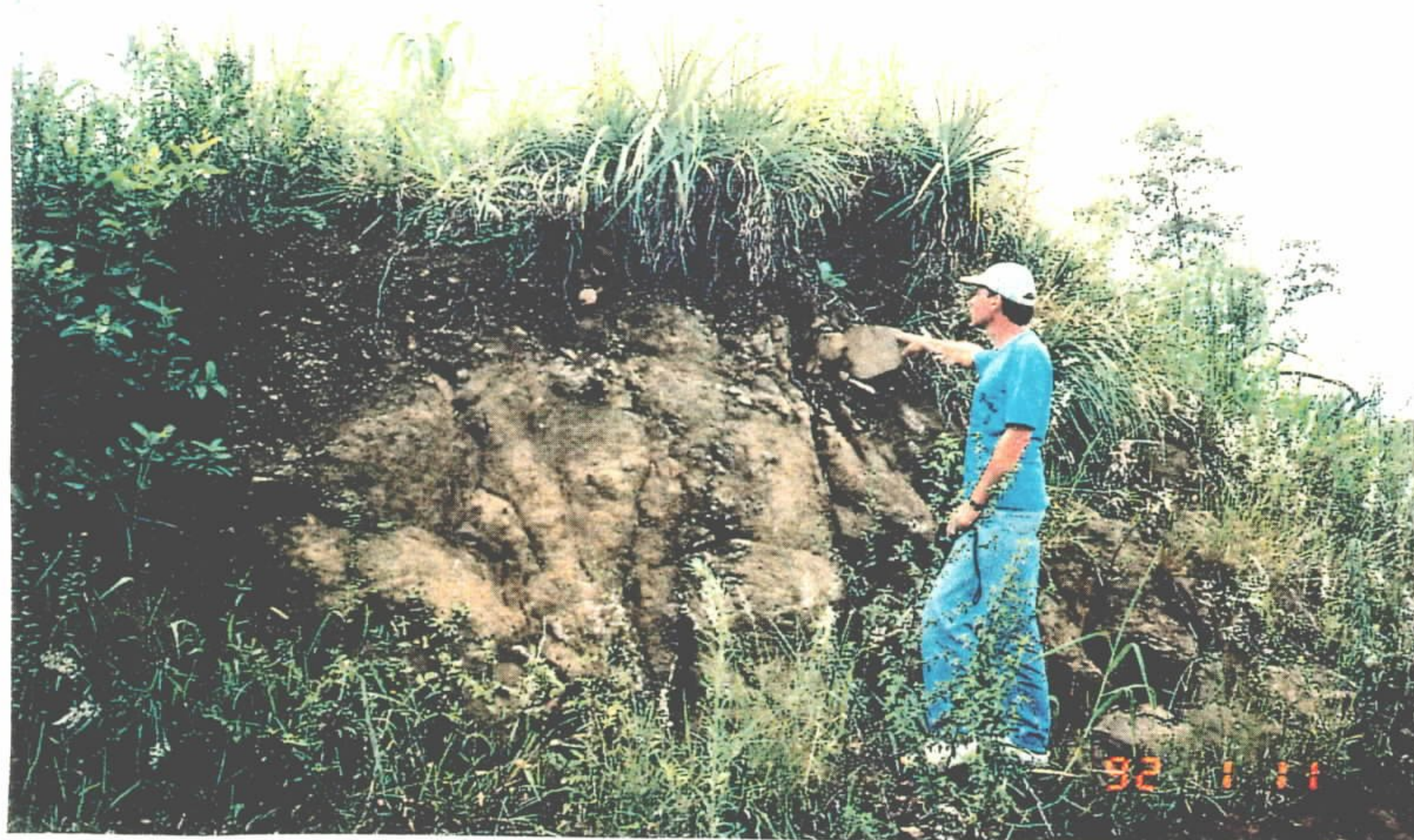
Foto 1 - Solo residual sobre rochas vulcânicas básicas. Nas bordas dos platôs ocorrem geralmente solos Litólicos ou Cambissolos, pouco espessos, com alto índice de pedregosidade.
