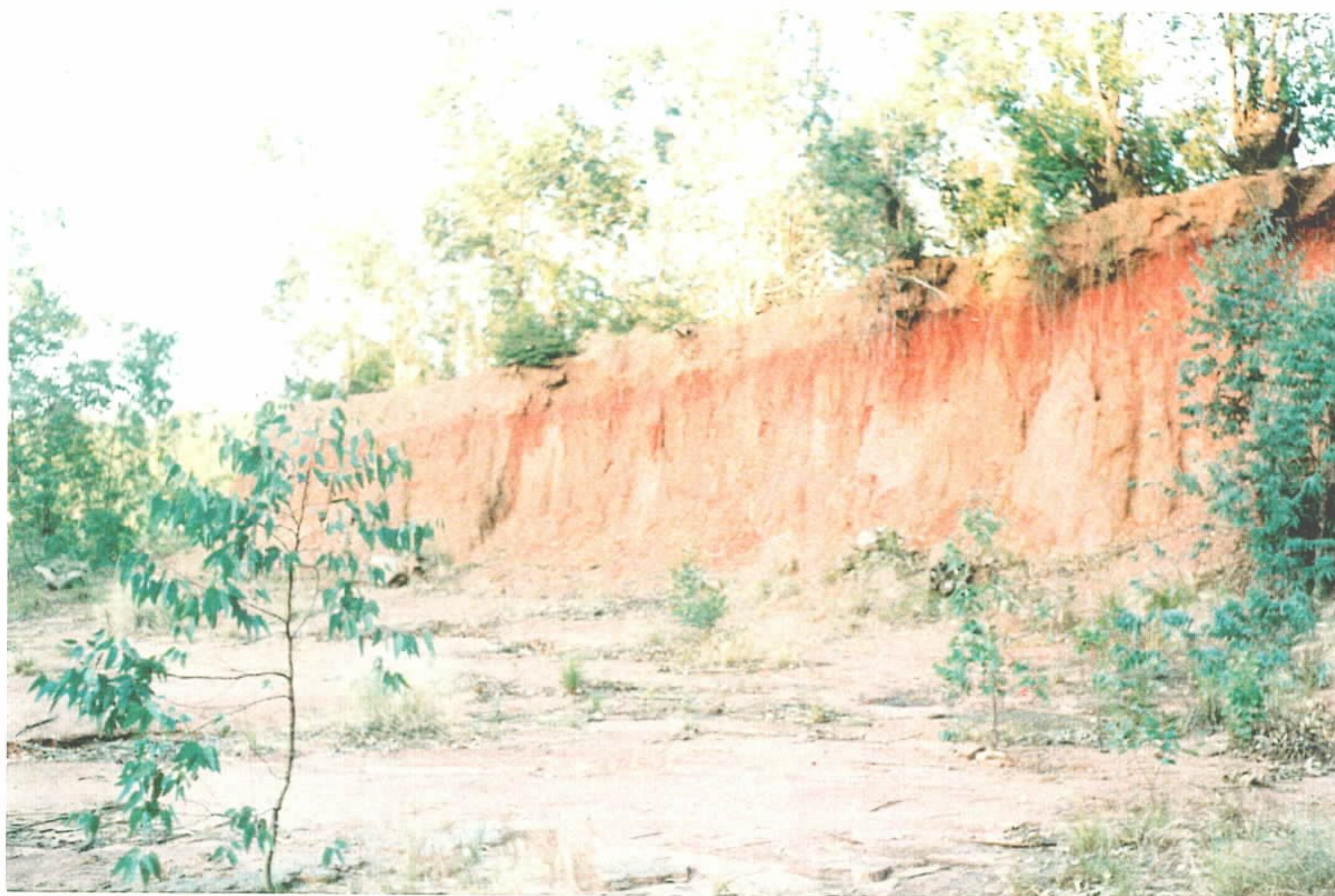
Foto 2 - Solo residual sobre rochas areníticas. Quando em topografia ondulada são muito suscetíveis aos processos erosivos. Possuem capacidade de carga e compactação médias e o nível freático é profundo, com profundidade normalmente superior a 6 metros.
