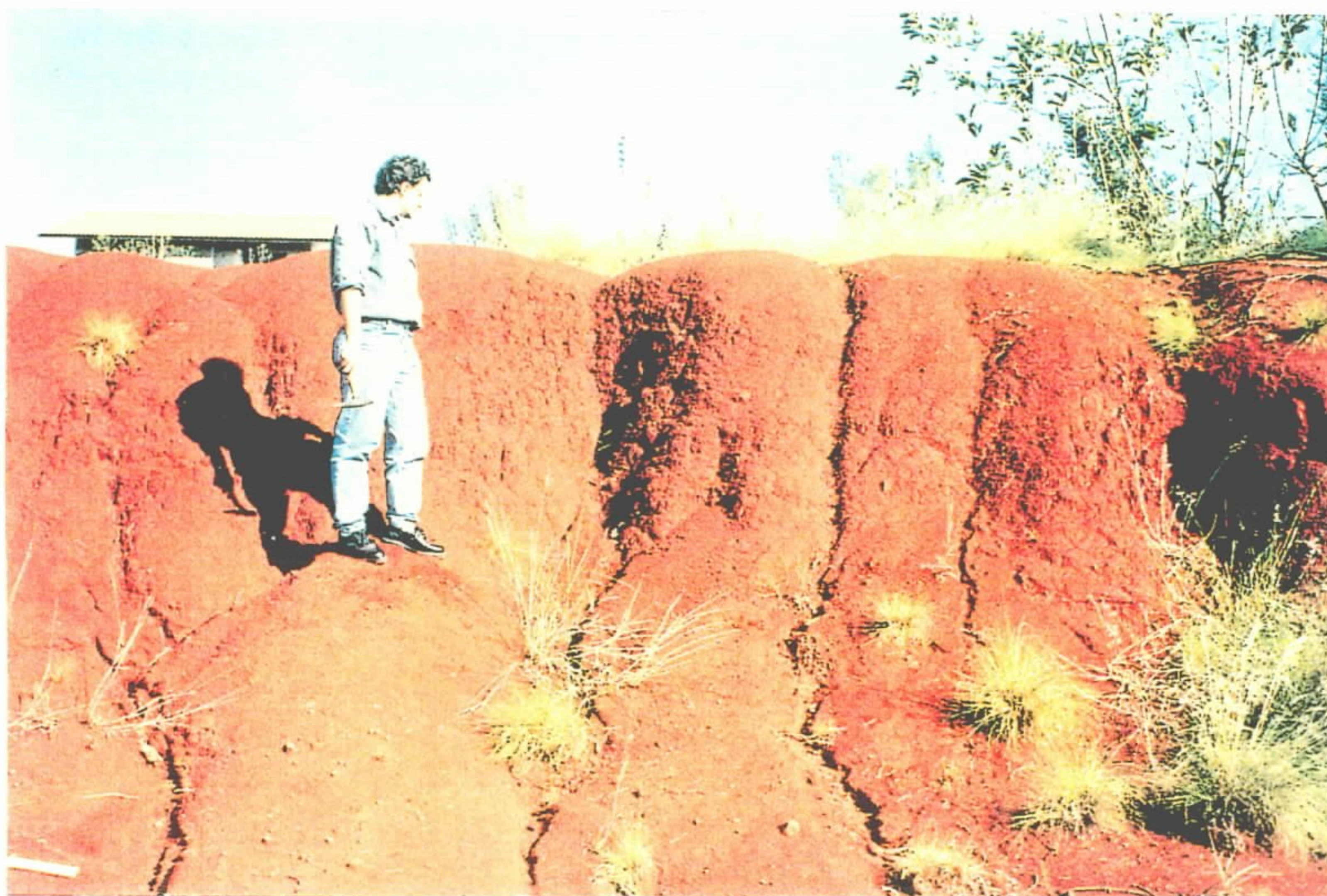
Foto 4 - Solo residual sobre substrato constituído por basaltos e arenitos (zona de contato). Apresenta cor vermelha-escura, granulometria predominantemente argilosa, consistência e capacidade de carga médias, e espessuras superiores a 3 m.
