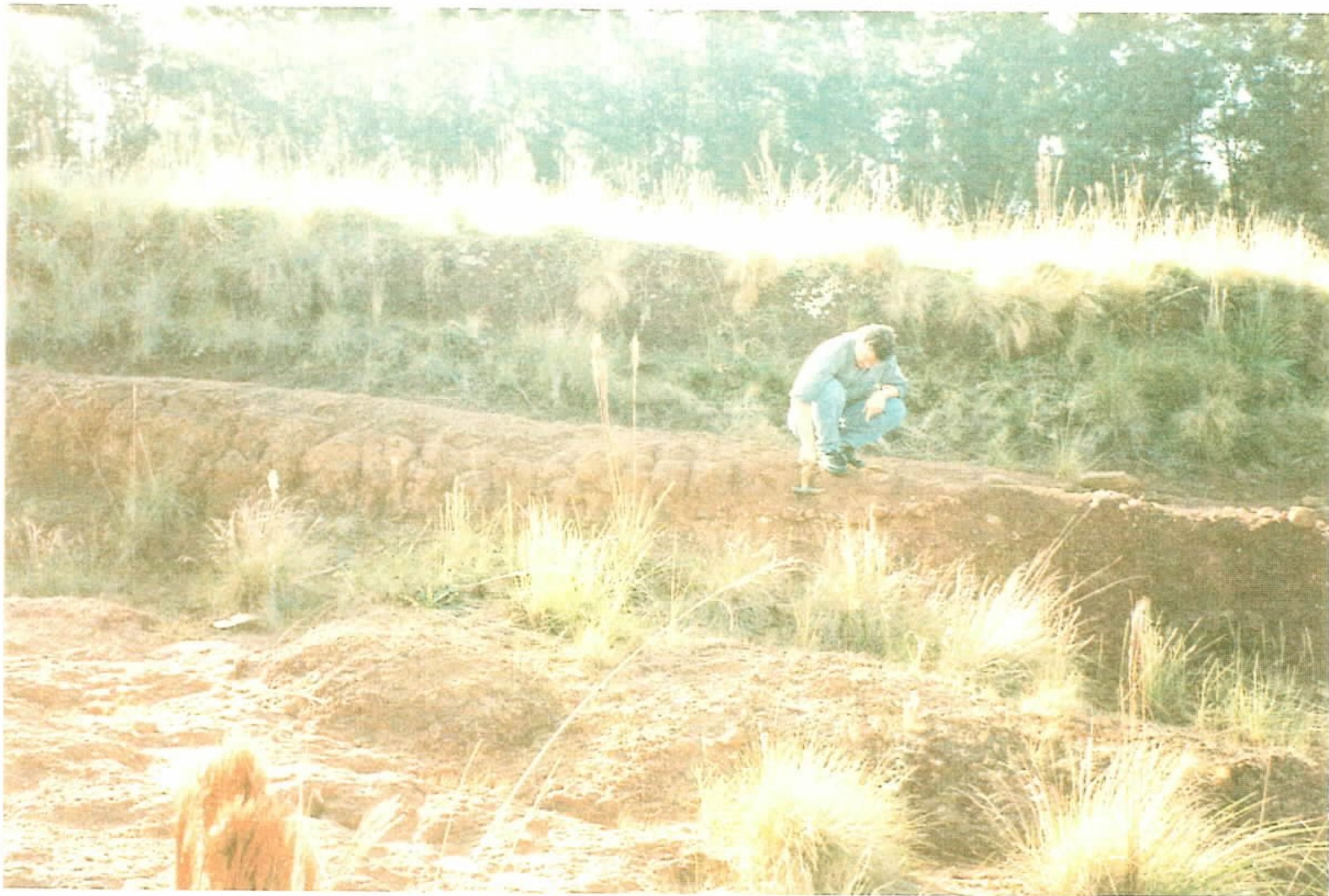
Foto 7 - Material coluvionar sobre rochas areníticas. Na base, às vezes apresentam níveis de seixos como mostra a foto. Possui compacidade e capacidade de carga moderadas.
