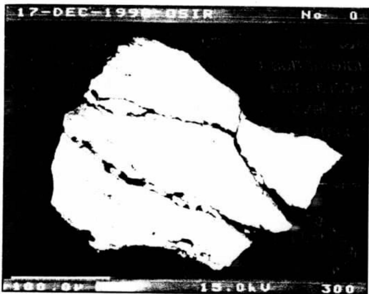
Foto 25 - Imagem de elétrons retro espalhados (BSE) onde se identifica um grão de ósmio com bordas irregulares e arestas vivas (alta dureza) e de superfície homogênea.
