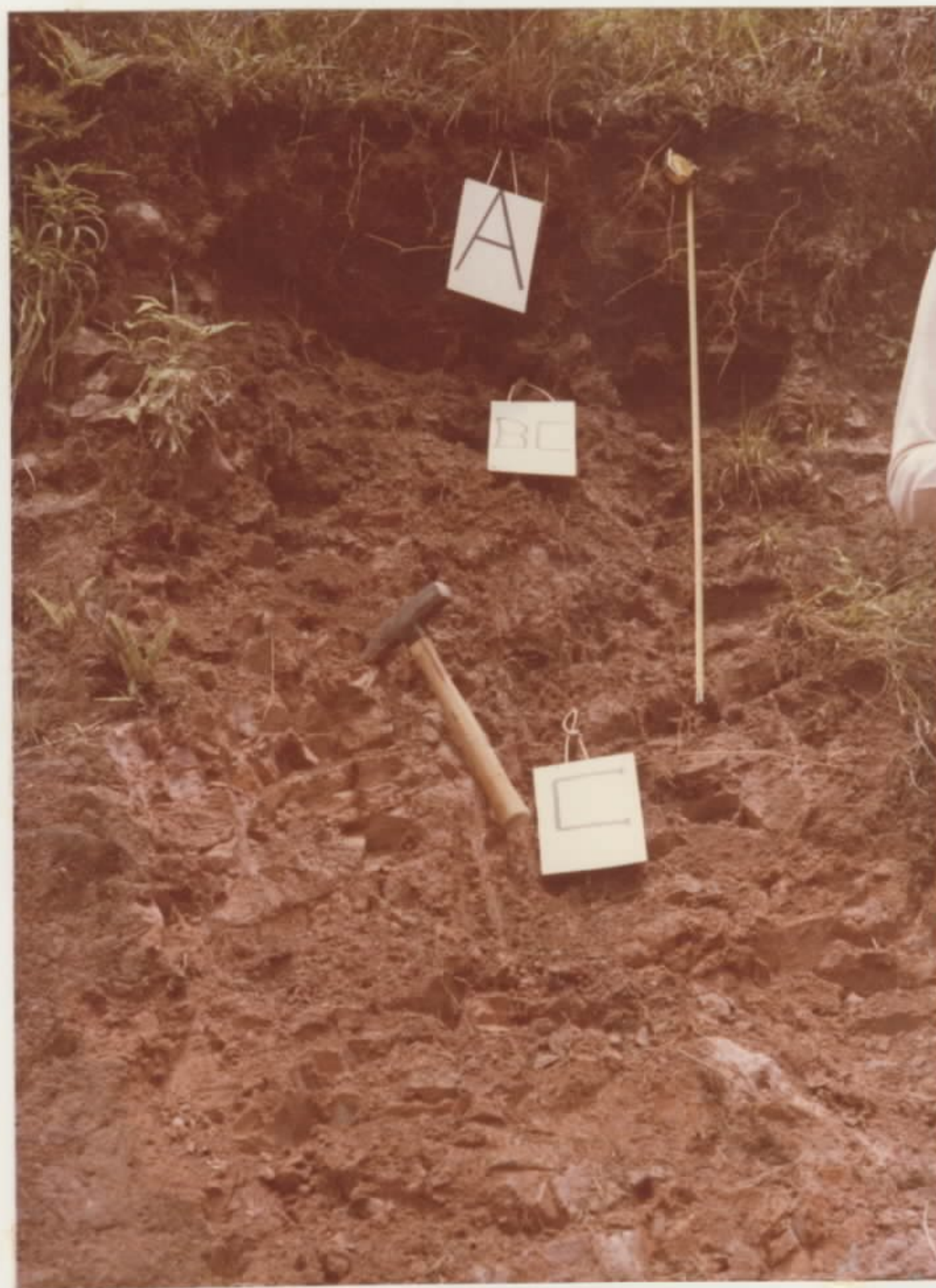
Foto nº 4 - Solo litó- lico sobreposto a ro- cha andesítica. Embo- ra o manto de intempé- rico seja muito espes- so, a faixa predomi- nantemente pedogênica mostra-se bastante - delgada.
