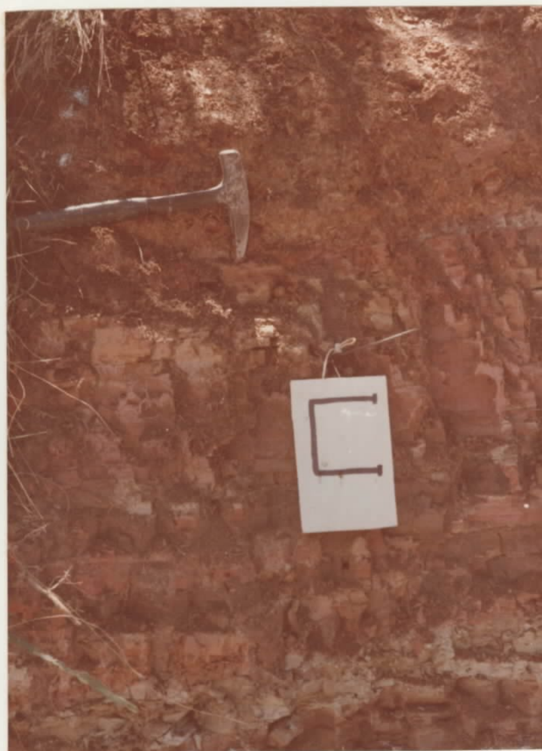
Foto nº 10 - Detalhe da marcante passagem do ma- terial pedológico para o lítico, sugerindo um escorregamento.
