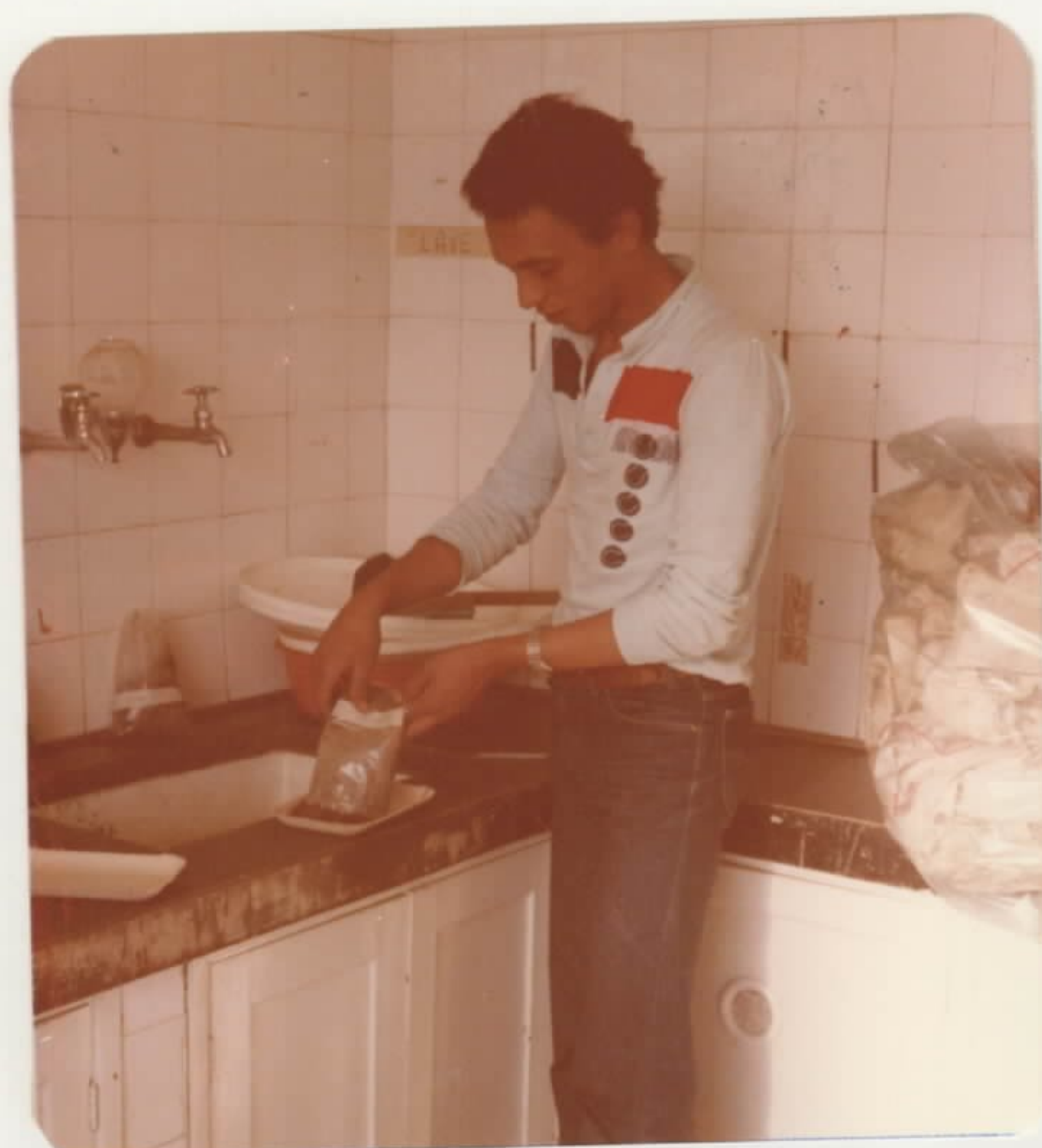
Foto nº 22 - Aspecto da deposição da amostra no recipiente, antes de ir à es tufa.
