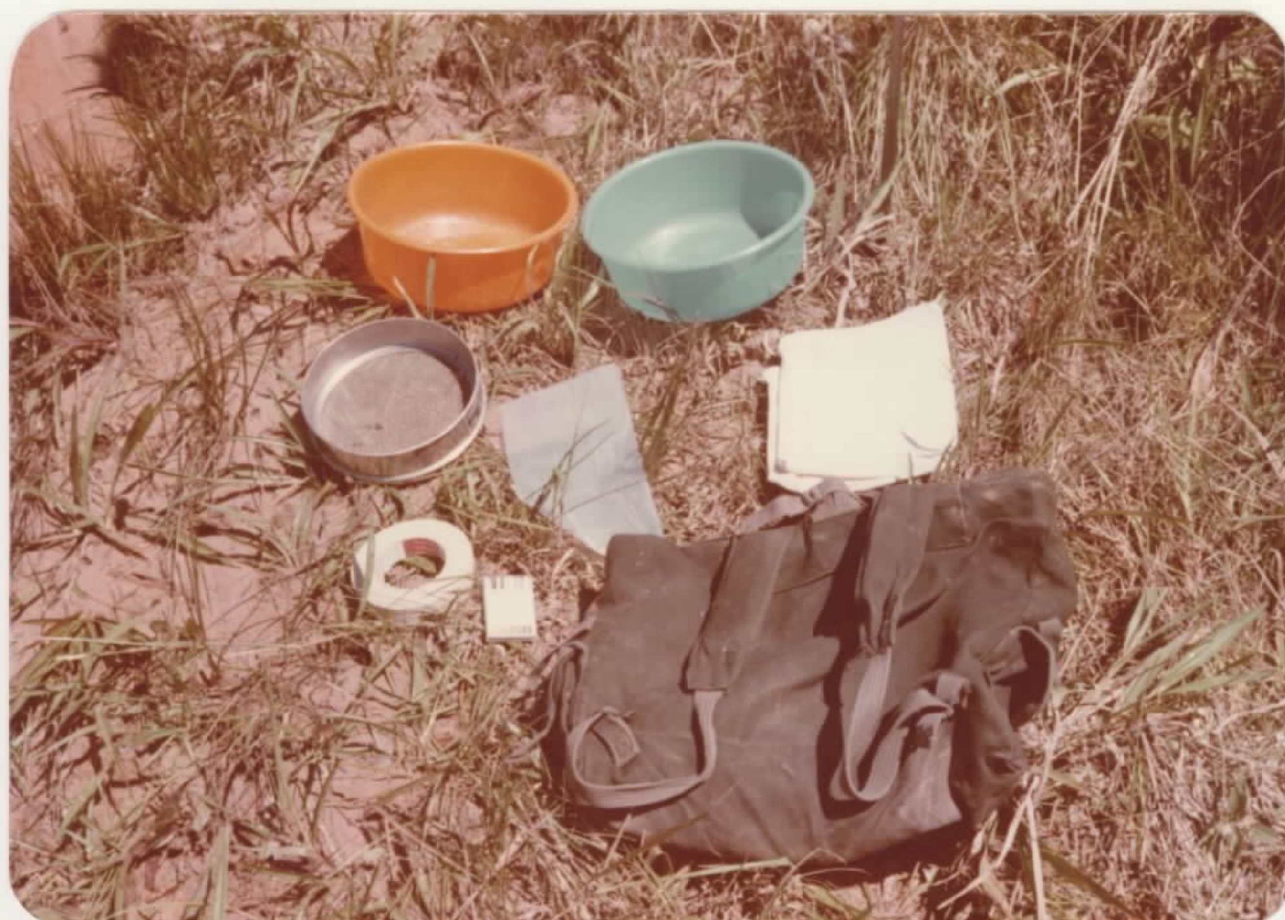
Foto nº 15 - Equipamento utilizado na coleta de sedimento de corrente.
