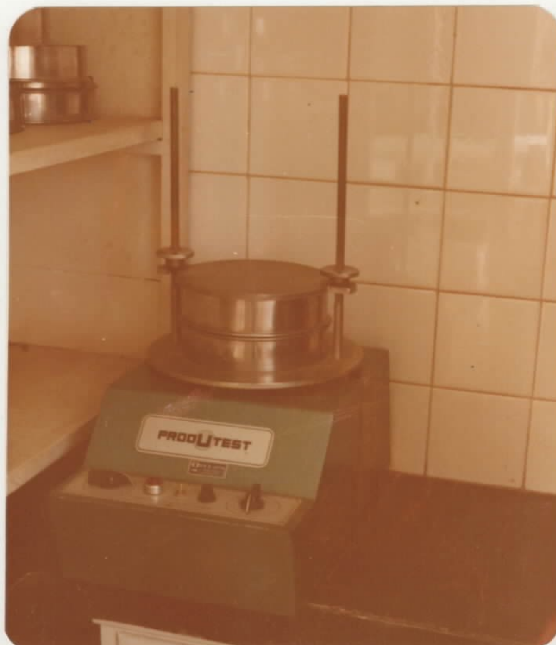
Foto nº 24 - Vibrador para peneiramento da amostra já seca.
