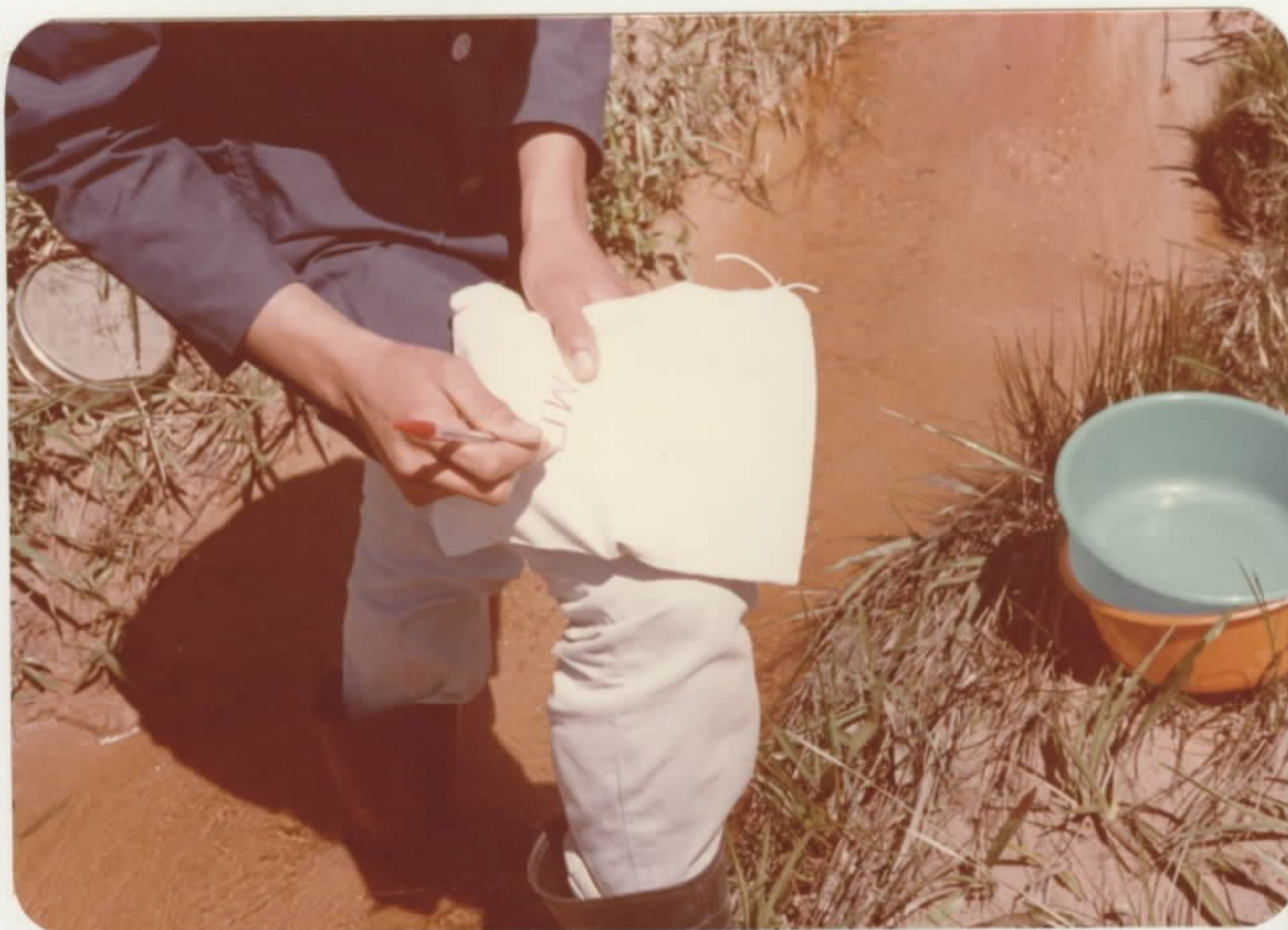
Foto nº 19 - Etiquetagem da amostra, identificada pela sigla do coletor e número da estação.
